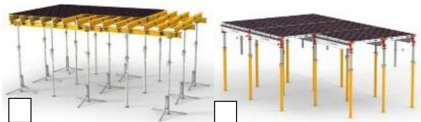
Рис. 1. Види опалубних систем для влаштування монолітних плит перекриття: а – балочна, б – щитова
