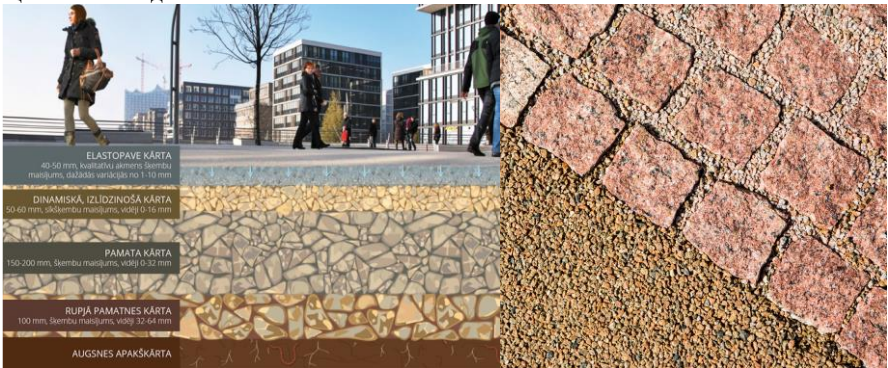
Рис. Рекомендована схема влаштування покриття Elastopave для пішохідного тротуару
