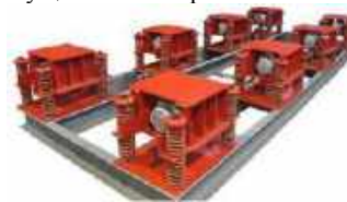
Рисунок 1. Вібромайданчик для ущільнення бетонної суміші у змінних формах
