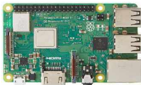
Рисунок 1. Мікрокомп'ютер Raspberry Pi 3B+
