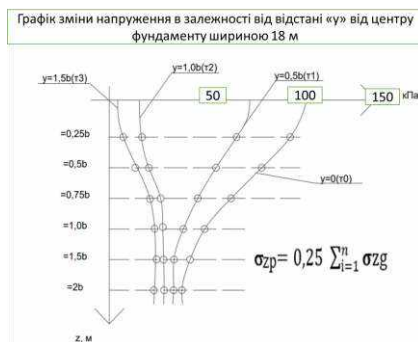
Рисунок 3. Розподіл напружень під підшовою на різній відстані від центру ваги фундаменту
