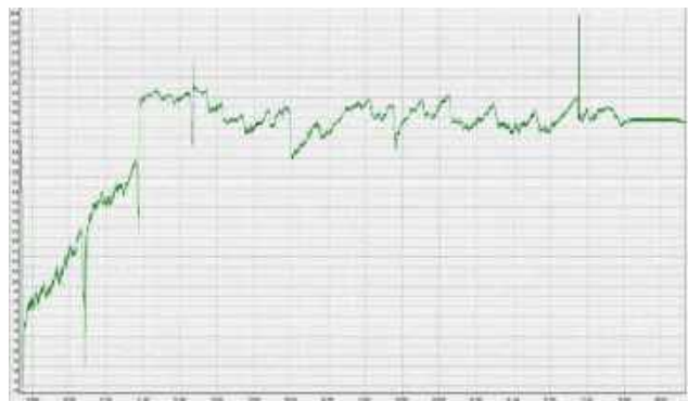
Рисунок 3. Осцилограма отриманих результатів різання ґрунту (парафіну)
