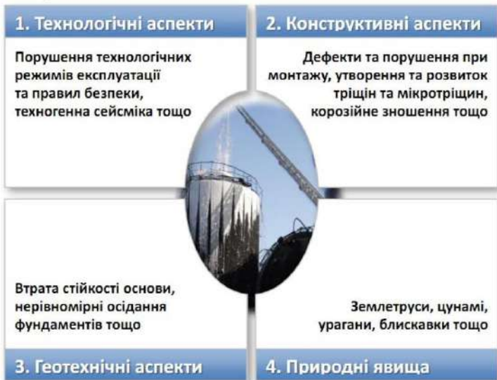
Рис. 2 Домінуючі аспекти основних причин аварій резервуарів
