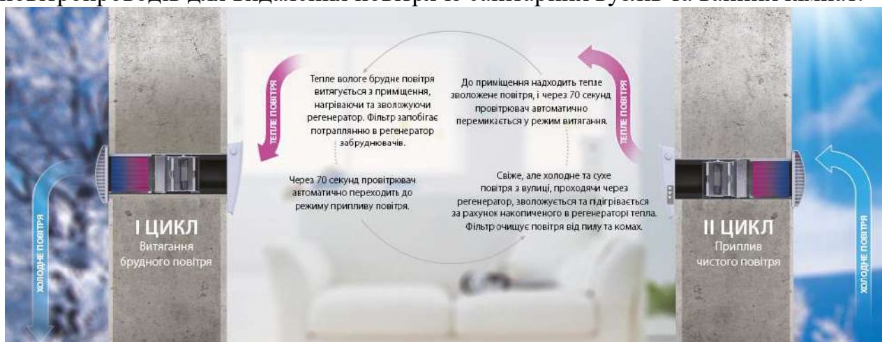
Рис. 1. Принцип роботи провітрювача Vents Twin Fresh [1]
