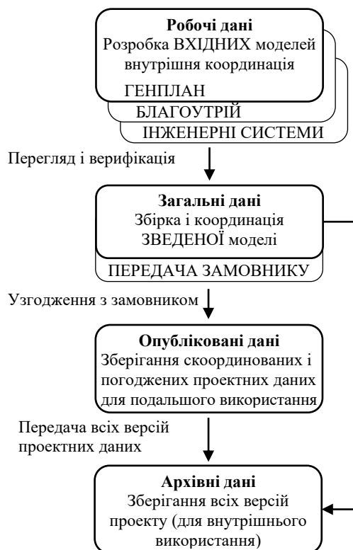
Рисунок 2. Структура середовища загальних даних для BIM-моделювання
