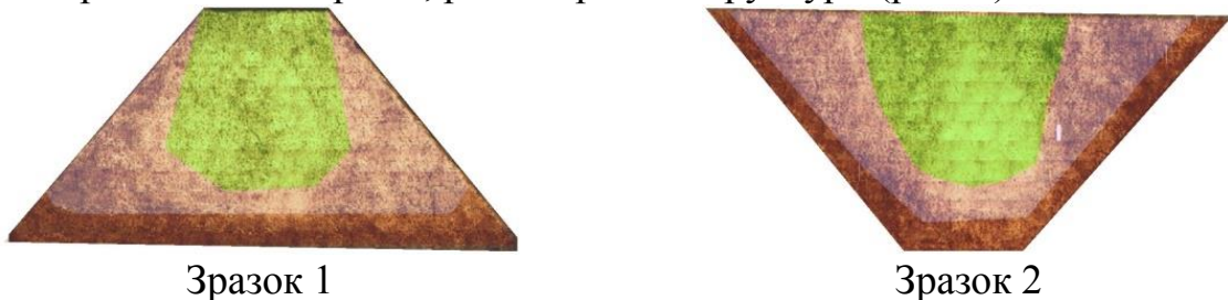
Рис. 3. Схема впливу геометрії на рівновісність треків, рівномірність структури.
