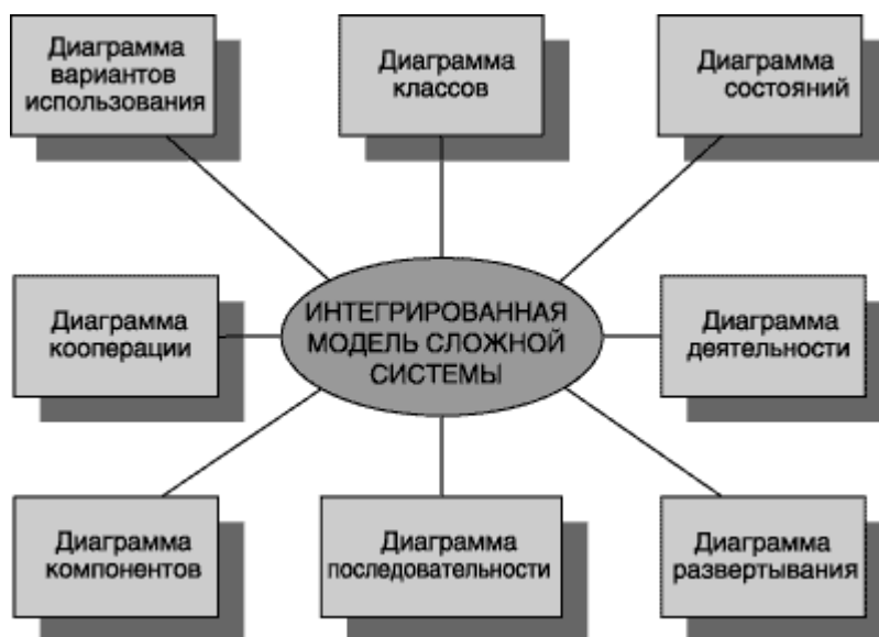
Рис. 2. Интегрированная модель сложной системы в нотации UML
