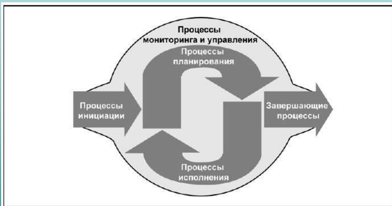
Рисунок 3-2. Соответствие между группами процессов управления проектом и элементами цикла "планирование-исполнение-проверка-воздействие"
