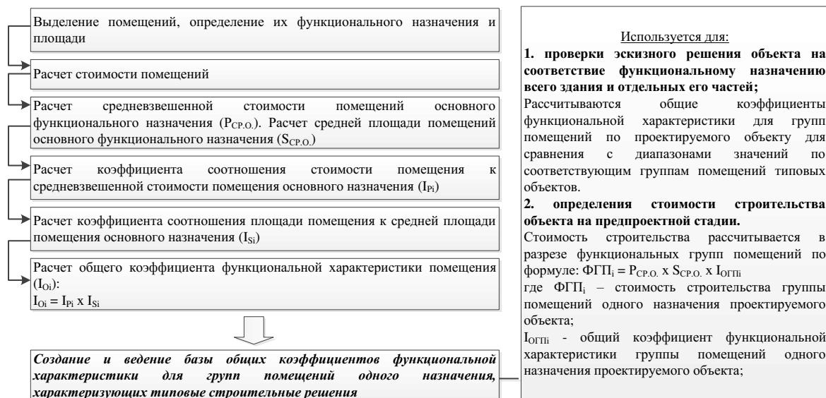
Рис 3. Порядок применения стоимостных показателей строительства помещений различного функционального назначения в разработке архитектурно-планировочных решений
