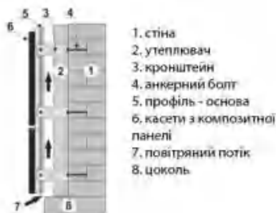
Рис. 2. Розширення вентильованого фасаду
