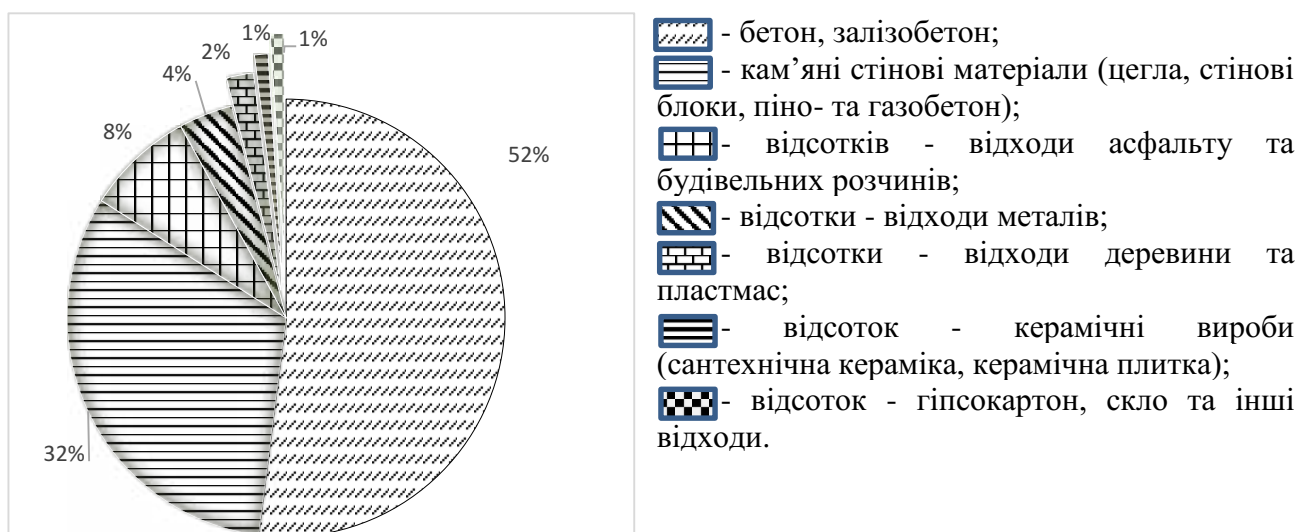
Рис.1. Структура відходів на будівельному майданчику
