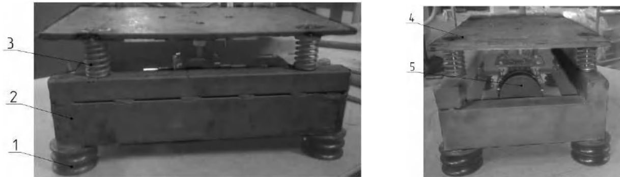
Рис. 3.1. Експериментальна двомасна віброустановка
