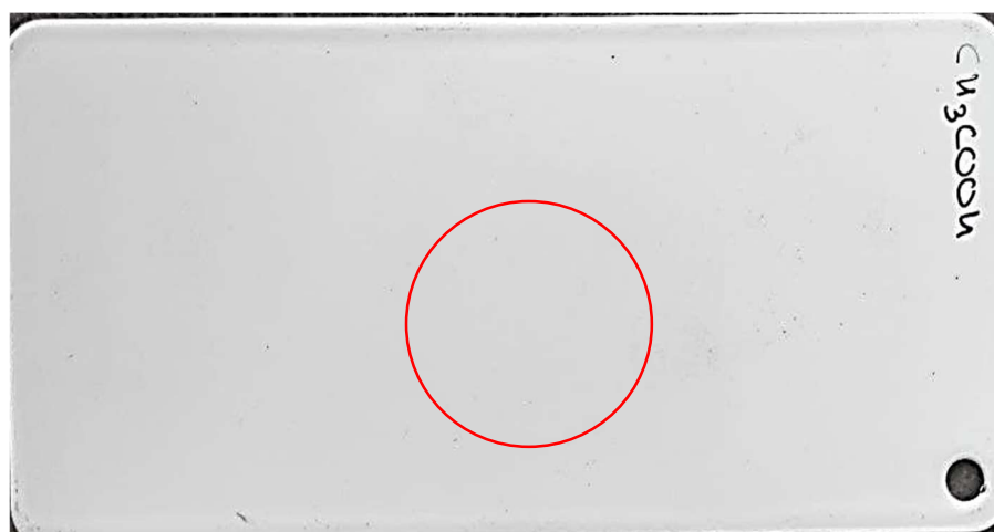
Рис. 4.26. Візуальний вигляд поверхні покриттів (згідно табл. 4.5) через 1 годину дії 40 % розчину сірчаної кислоти: а) контрольний склад «акрилове покриття»; б) Склад №11.
