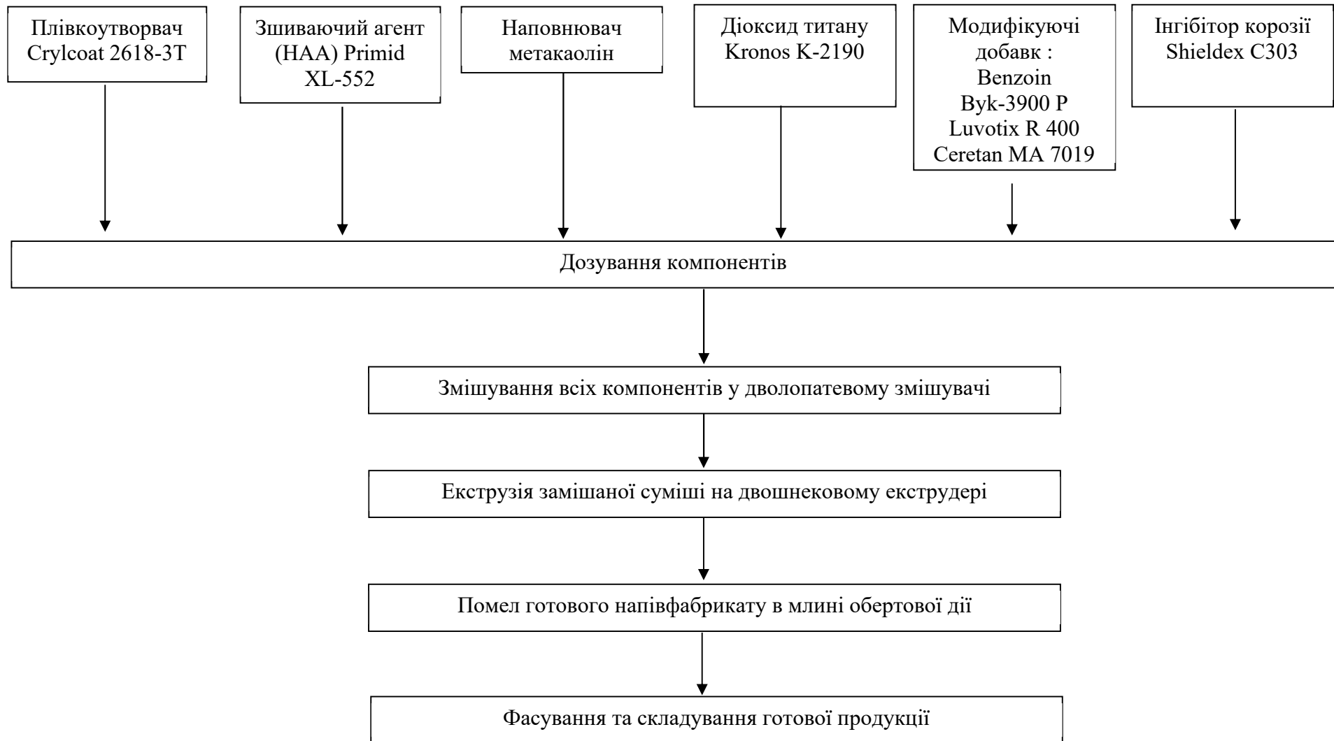
Рисунок 5.1. Технологічна схема виробництва порошкової фарби.
