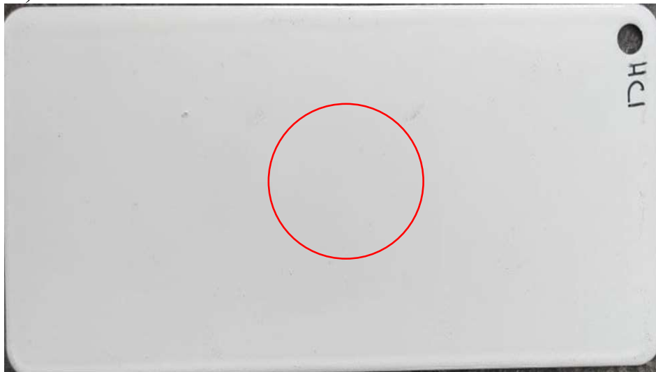
Рис. 4.28. Візуальний вигляд поверхні покриттів (згідно табл. 4.5) через 1 годину дії 30 % розчину соляної кислоти: а) контрольний склад «акрилове покриття»; б) Склад №11.
