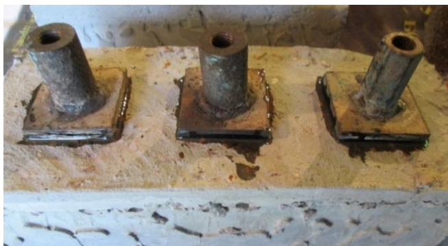
Рис. 2.3 – Загальний вигляд зразка з приклеєними пластинами для визначення міцності зчеплення шарів
