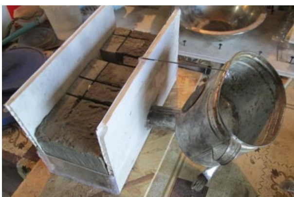
Рис. 2.12. Опалубна конструкція для відновлення нижніх поверхонь бетонних зразків: а) загальний вигляд; б) вид з боку
