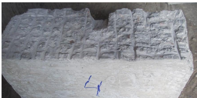
Рис. 3.5. Стан підготовки ремонтної поверхні бетонного зразка. а – поверхня не зачищена; б – поверхня зачищена; в – з насічками; г – штучно зруйнована
