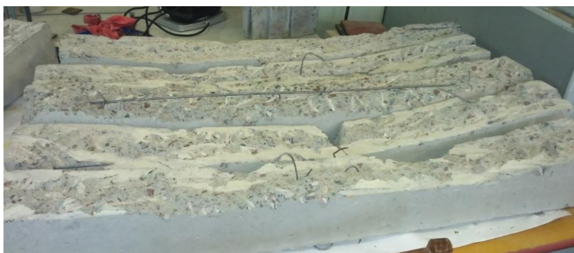
Рис. 4.9. Балки, підготовлені до відновлення: а – схема підготовленої балки; б – фото підготовленої балки (балки перевернуті догори)
