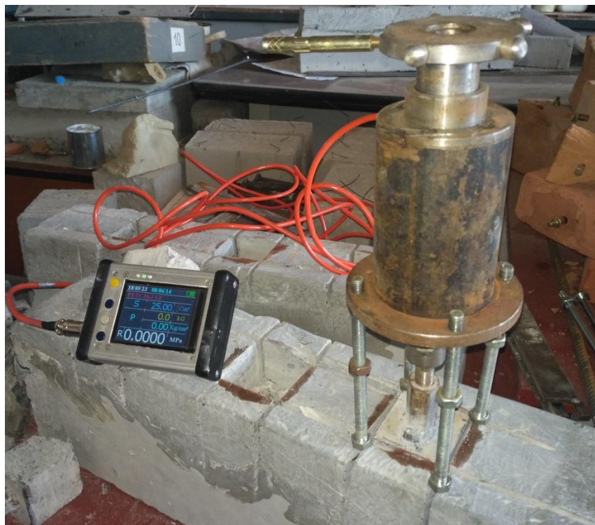
Рис. 2.2. – Процес визначення міцності зчеплення шарів конструкцій
