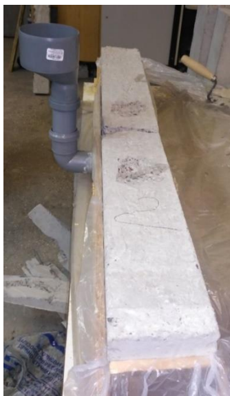
Рис. 4.10. Балка підготовлена до відновлення
