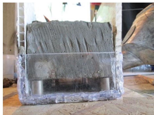
Рис. 2.12. Опалубна конструкція для відновлення нижніх поверхонь бетонних зразків: а) загальний вигляд; б) вид з боку
