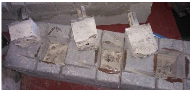
Рис. 4.11. Зразки після визначення міцності зчеплення з основою
