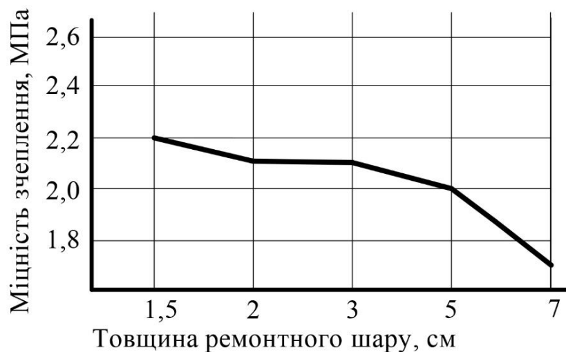
Рис. 3.10. Залежність міцності зчеплення ремонтного розчину з основою від товщини відновлюваного шару
