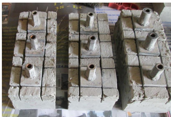
Рис. 2.4. – Загальний вигляд зразків, підготовлених до визначення міцності зчеплення шарів
