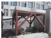
Рис. 2– Установка для випробувань конструктивно – анізотропної плити
