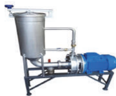
Рис. 2. - Лабораторний ротаційний гідродинамічний гомогенізатор
