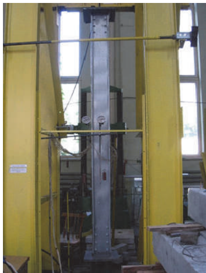
Рис. 1. Експериментальне випробування колони, виконаної з тонкостінних гнутих профілів.
