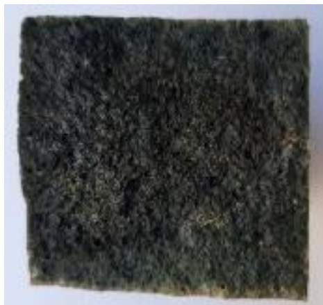
Рисунок 4.1 – Фотографії перерізів половинок зразків: а, б – склади ШСПО і ШМПО після розбризкування розчину 0,1 М \text{AgNO}_3 ; в, г – склади ШСПО і ШМПО після розбризкування розчину 0,5 Н ацетату свинцю (II).
