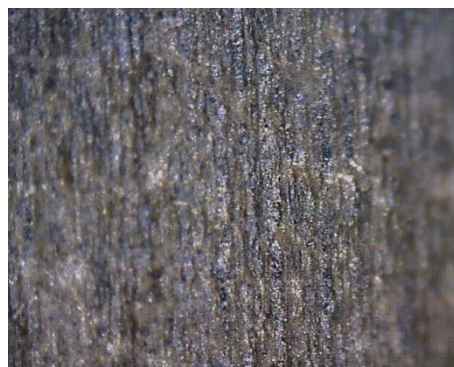
Рисунок 5.4 – Стан сталевих стрижнів, видобутих з пластифікованих шлаколужних бетонів на основі метасилікату натрію при твердненні впродовж 360 діб у воді: а – АМТ, б – АМН, в – АМТК, г – АМНК
