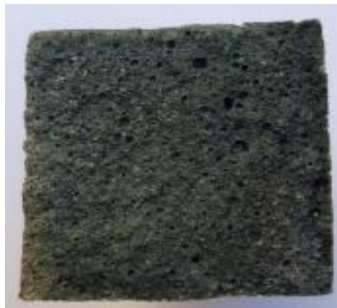
Рисунок 4.1 – Фотографії перерізів половинок зразків: а, б – склади ШСПО і ШМПО після розбризкування розчину 0,1 М \text{AgNO}_3 ; в, г – склади ШСПО і ШМПО після розбризкування розчину 0,5 Н ацетату свинцю (II).
