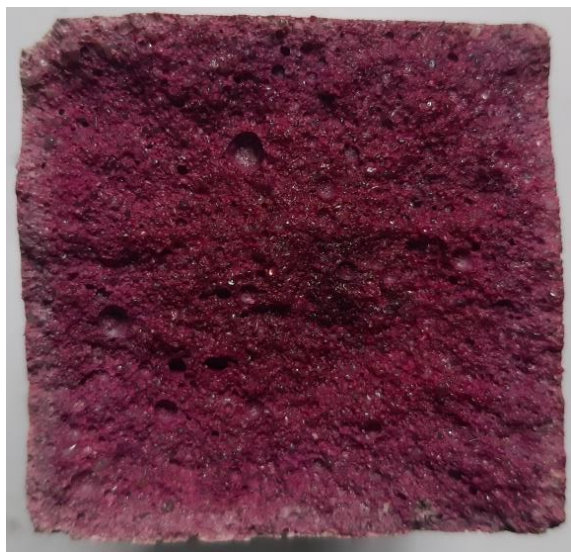
Рисунок 4.13 – Глибина карбонізації в структурі шлаколужного бетону на основі метасилікату натрію при твердненні впродовж 90 циклів зволоження і висушування: а – склад МК; б – склад МН; в – склад МТ; г – склад ММ
