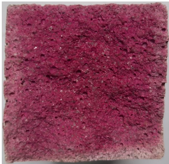
Рисунок 4.13 – Глибина карбонізації в структурі шлаколужного бетону на основі метасилікату натрію при твердненні впродовж 90 циклів зволоження і висушування: а – склад МК; б – склад МН; в – склад МТ; г – склад ММ
