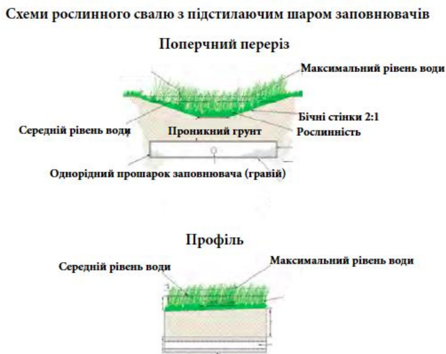
Рисунок 1.7 – Схема рослинного свалу з підстиляючим шаром заповнювача
