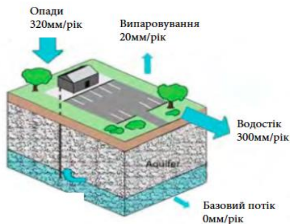
— Репрезентативний змінений водообіг під водонепроникною автостоянкою
