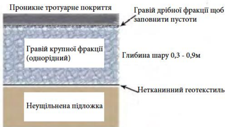
Рисунок 1.9 – Прошарки проникного тротуару.
