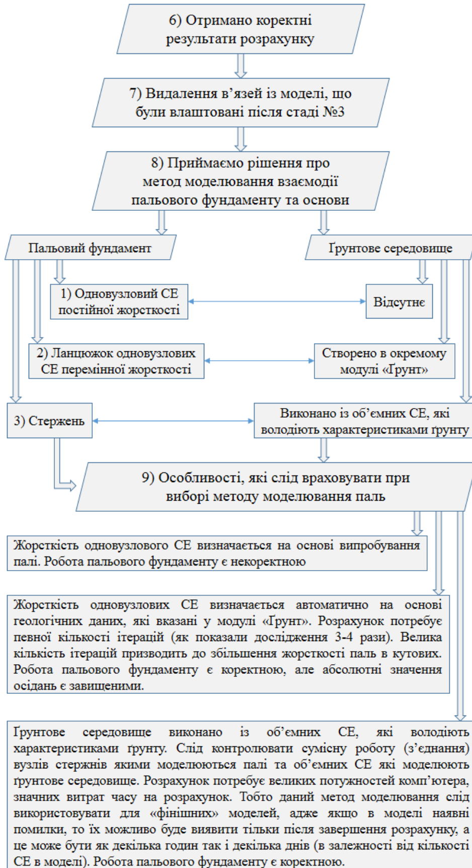
Рис. 3.3. Продовження блок-схеми методики числового моделювання взаємодії пального фундаменту з ґрунтовими основами із урахуванням зміни жорсткості конструкцій будівель та нелінійних процесів деформування матеріалів
