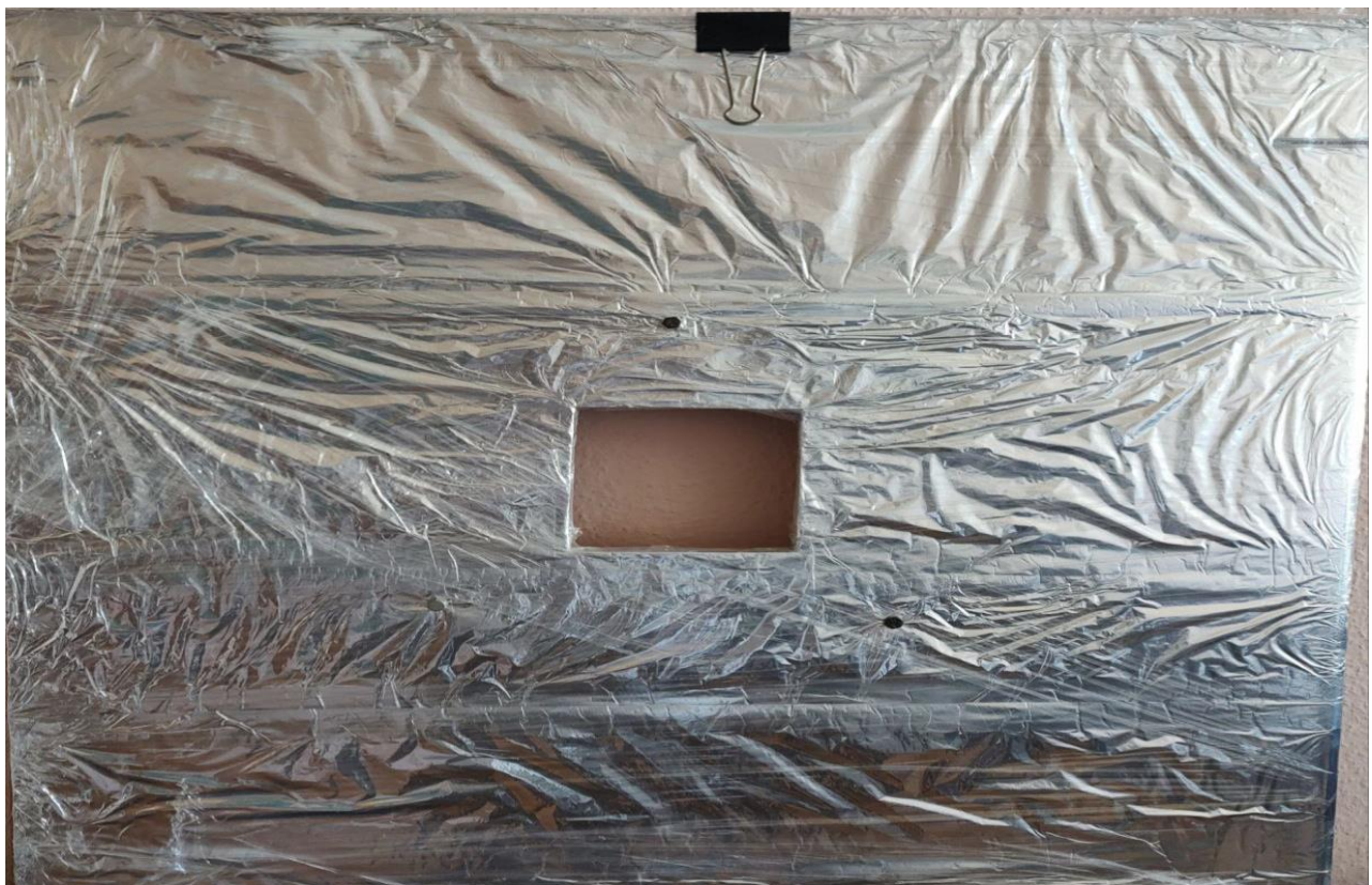
Рис. 2.2. Стенд для визначення коефіцієнта відбиття електромагнітних хвиль
