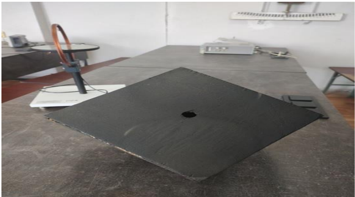
Рис. 2.1. Захисний екран для вимірювання ефективності захисту від електричної та магнітної складової електромагнітного поля наднизької частоти
