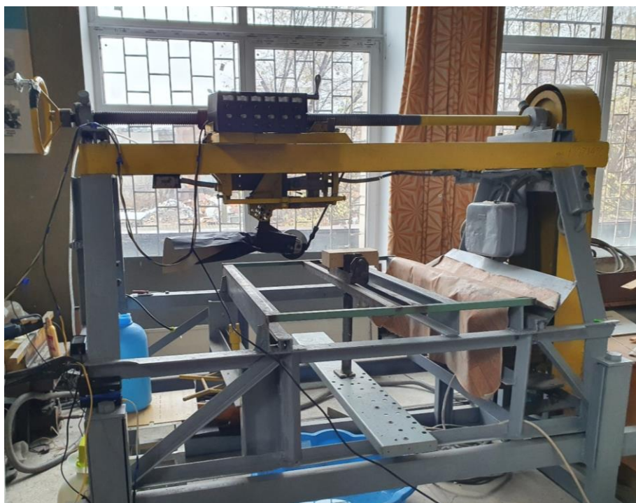
Рис. 3.1. Динамометричний стенд реєстрації силового навантаження авторської конструкції КНУБА.
