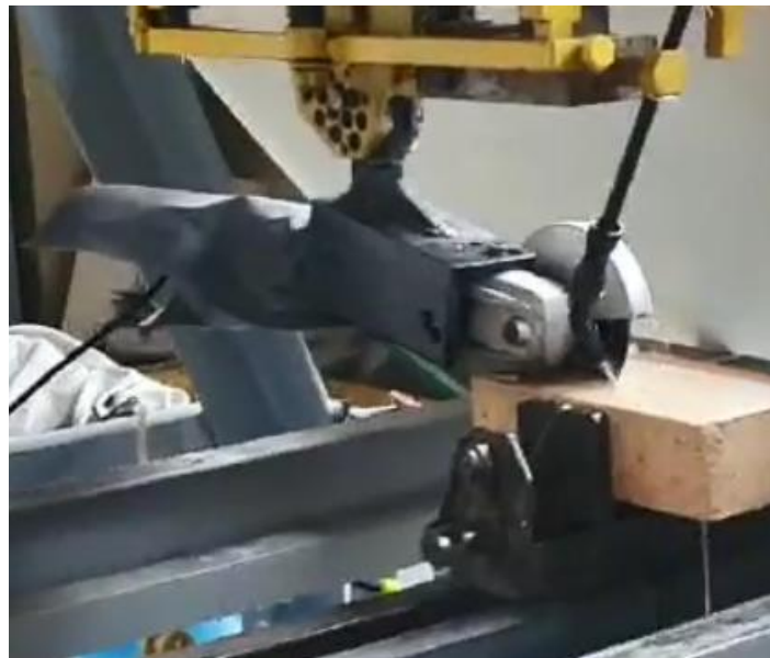
Рис. 3.20. Різання вогнетривкої цегли на динамометричному стенді.
