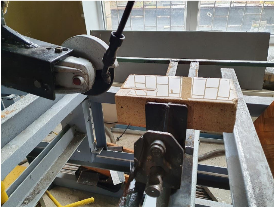
Рис. 3.3 Встановлення дослідного зразка на стенді
