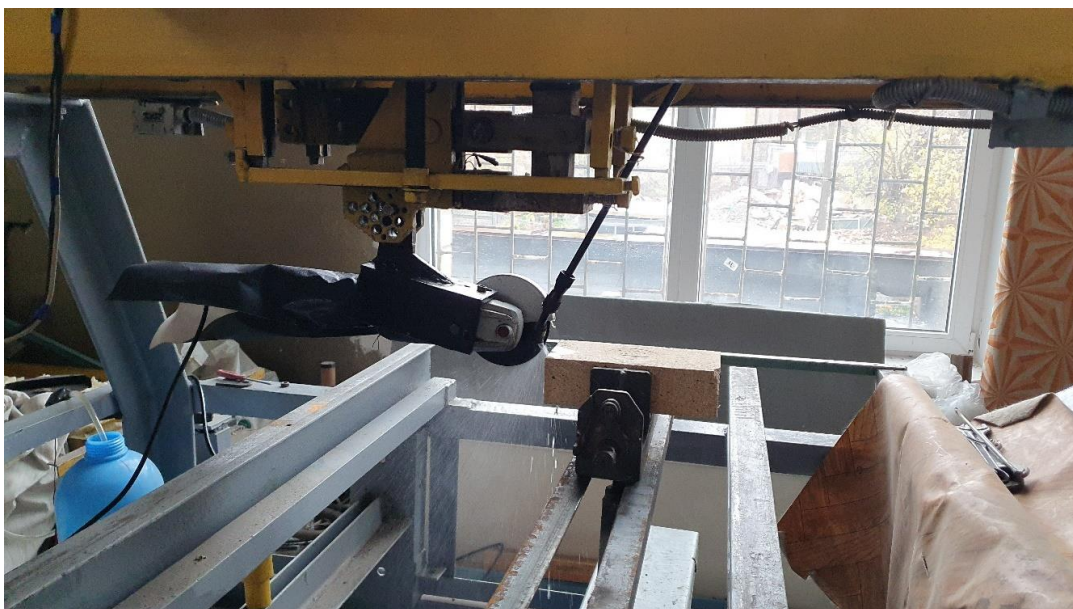
Рис. 3.21. Встановлення вогнетривкої цегли на динамометричний стенд.
