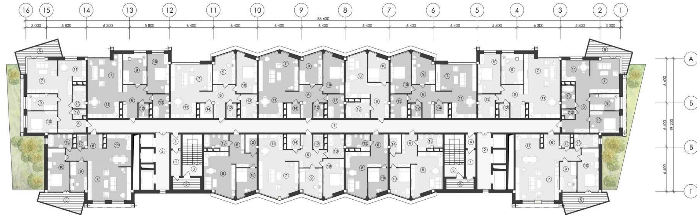
План типового поверху секції 5 та 6 на відмітці +7200 М 1:200
