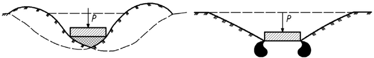
Рис. 2.5. Схема залежності між осіданням і навантаженням
