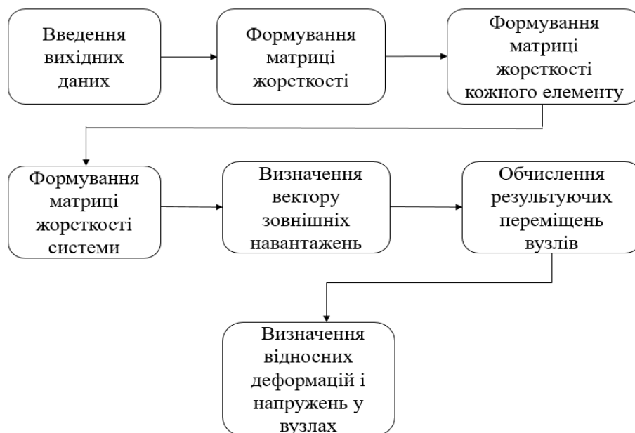
Рис. 1.15. Етапи розрахунку математичної моделі методом скінченних елементів
