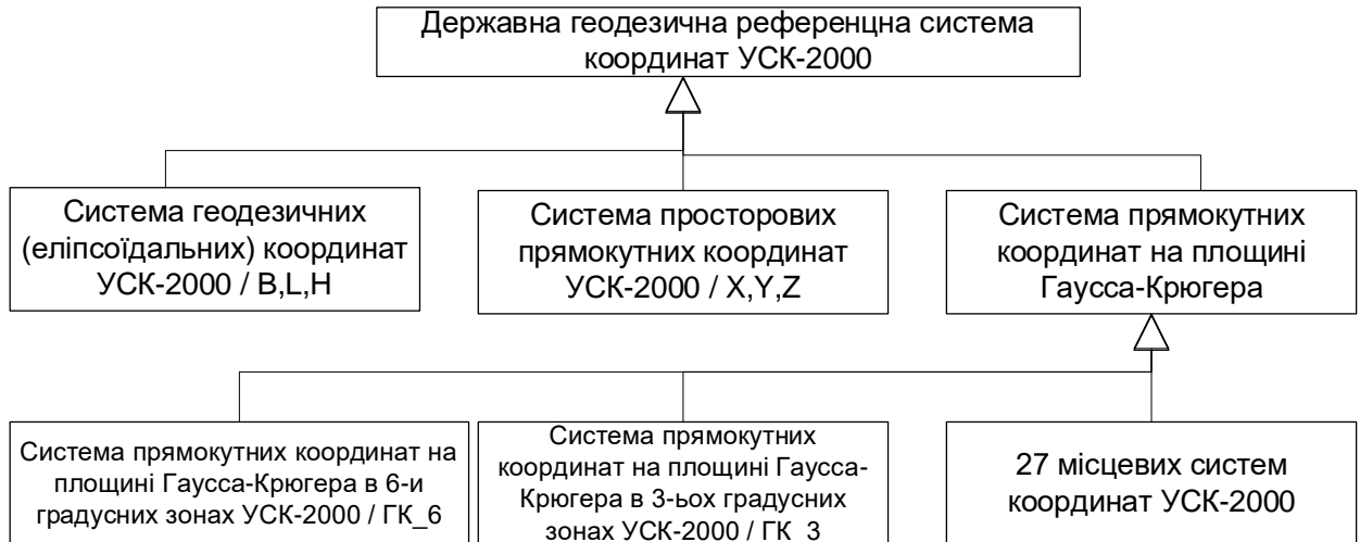
Рисунок 1.4 – UML – діаграма структури Державної геодезичної референцної системи координат УСК-2000 [137]
