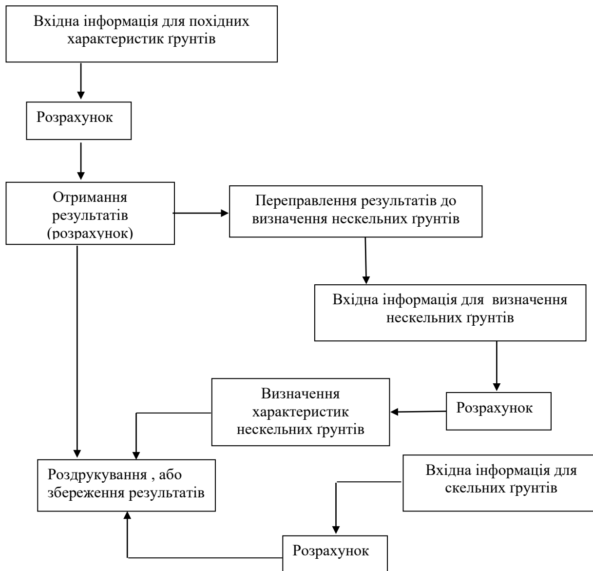
Рисунок 4 - Схема визначення даних для проведення розрахунку
