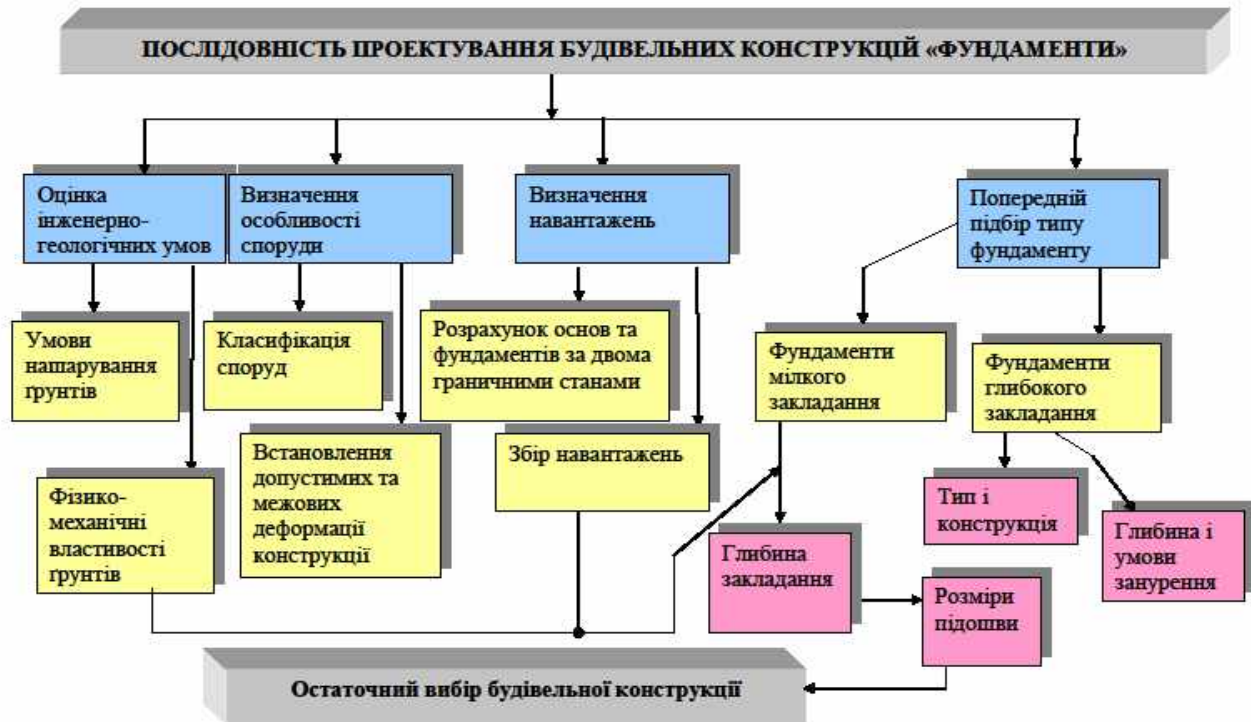
Рисунок 2 - Послідовність проєктування будівельних конструкцій і споруд
