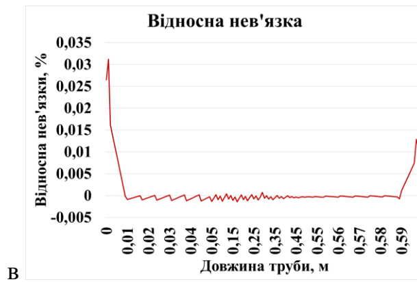
Рис. 2.27. Графічні залежності зміни значень відносної нев'язки по довжині трубки: а) товщина теплової ізоляції 0,02 м; б) товщина теплової ізоляції 0,05 м; в) товщина теплової ізоляції 0,1 м
