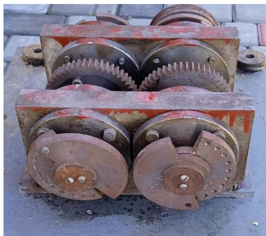
Рисунок 3.5 – Відцентровий вібраційний збудник.
