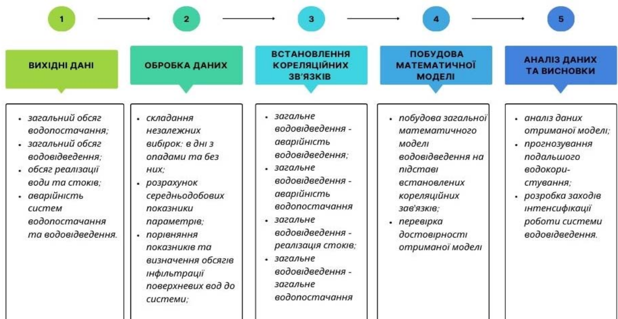
Рис. 3.2. Процес визначення інфільтрації та ексфільтрації балансово-аналітичним методом.
