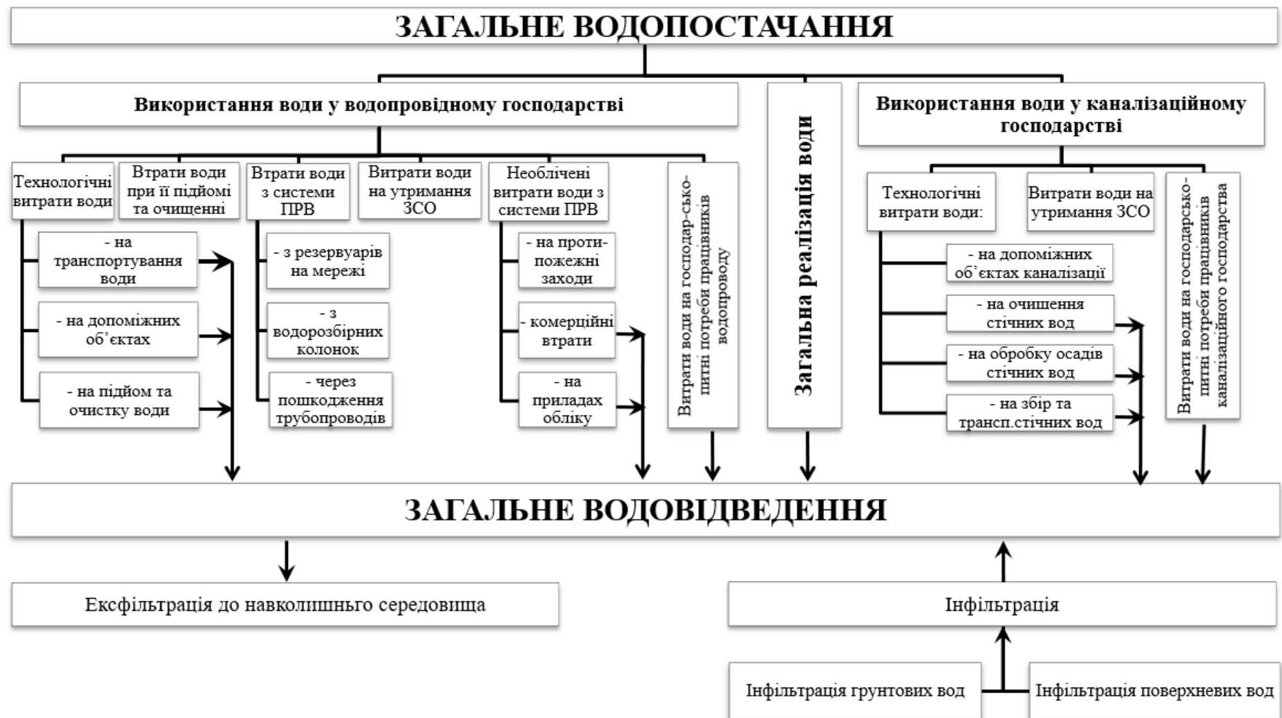
Рис. 3.3. Загальний баланс водокористування
