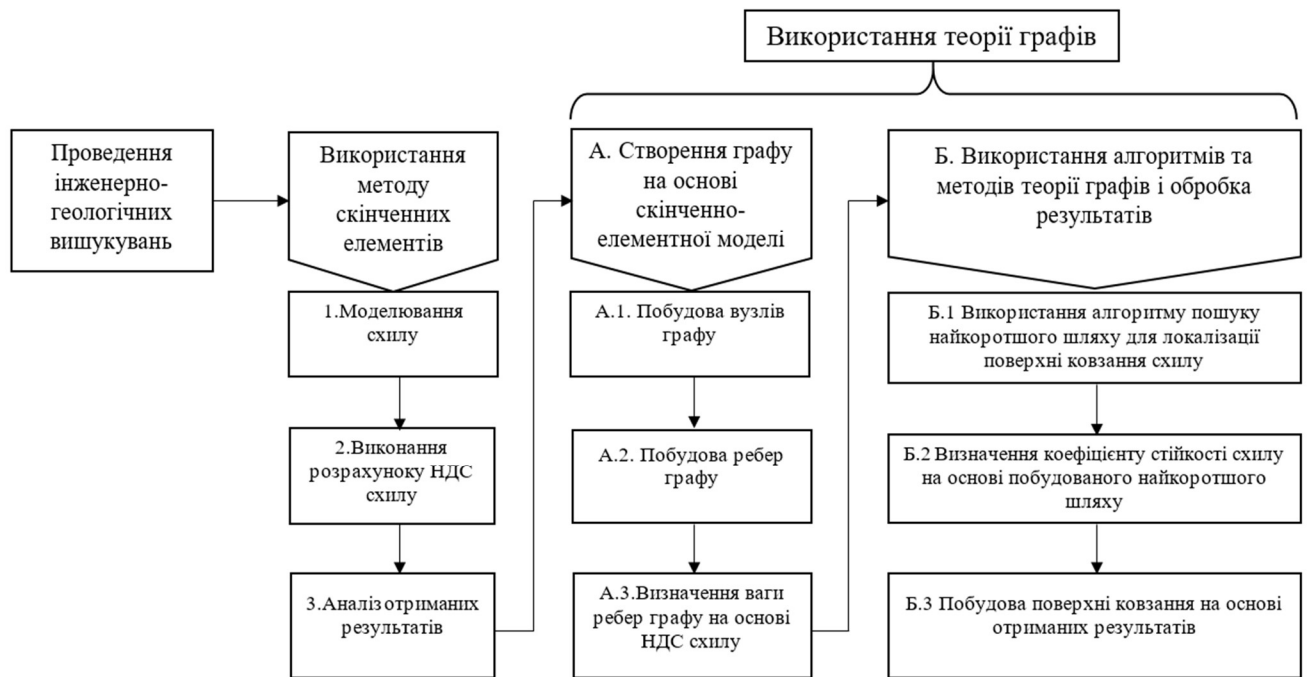
Рис.3.7. Схема алгоритму використання запропонованого підходу
