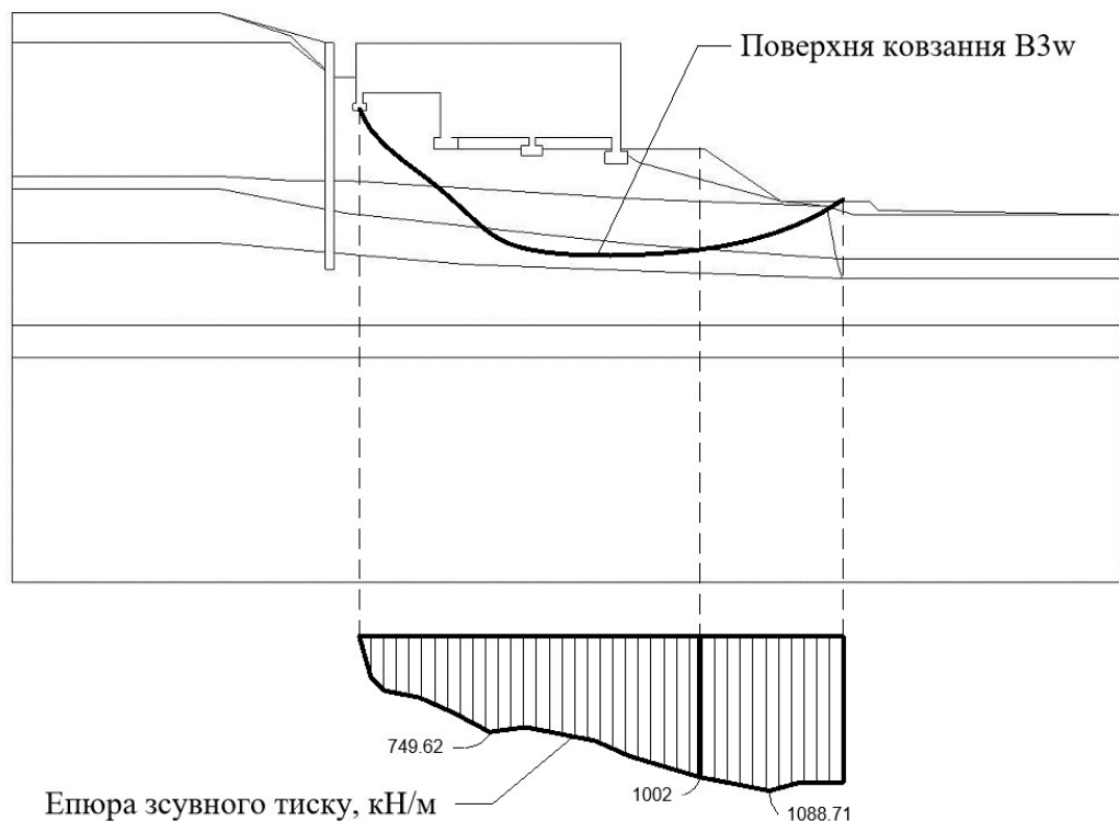
Рис. 4.30. Епюра зсувного тиску, що відповідає поверхні ковзання В3w, кН/м
