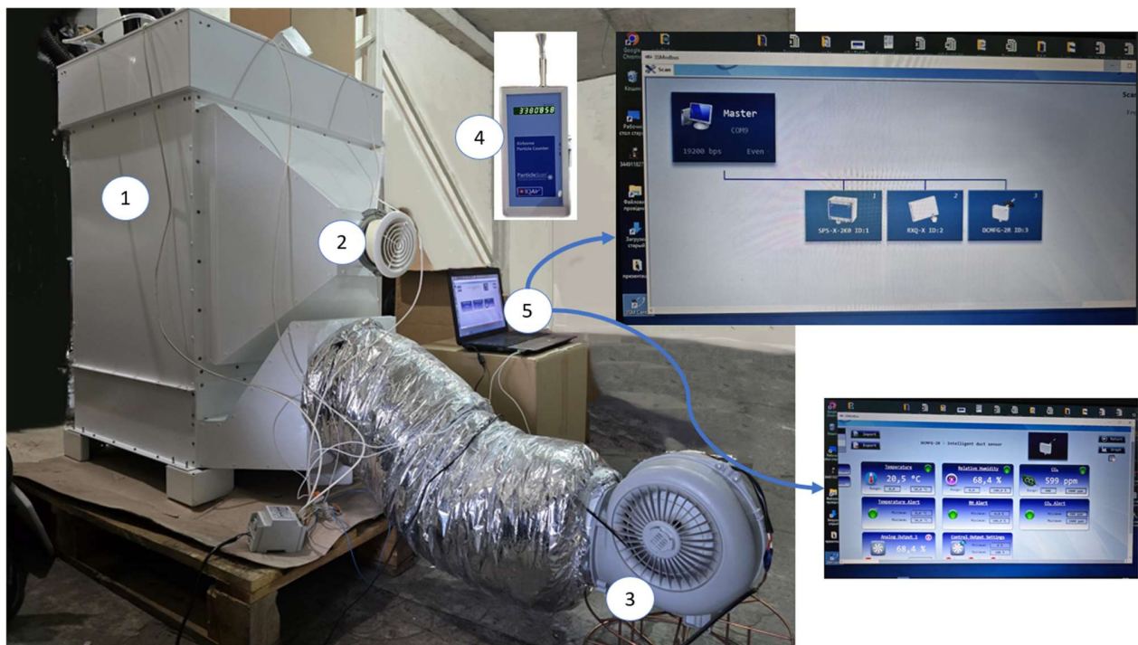
Рис. 3.2. Фото розміщення експериментальної установки. 1 - фільтр-теплообмінник; 2 - вентилятор подачі повітря зовні; 3-рециркуляційний вентилятор; 4 - датчика частинок РМ Particle Scan Lite; 5-пристрій обробки інформації.
