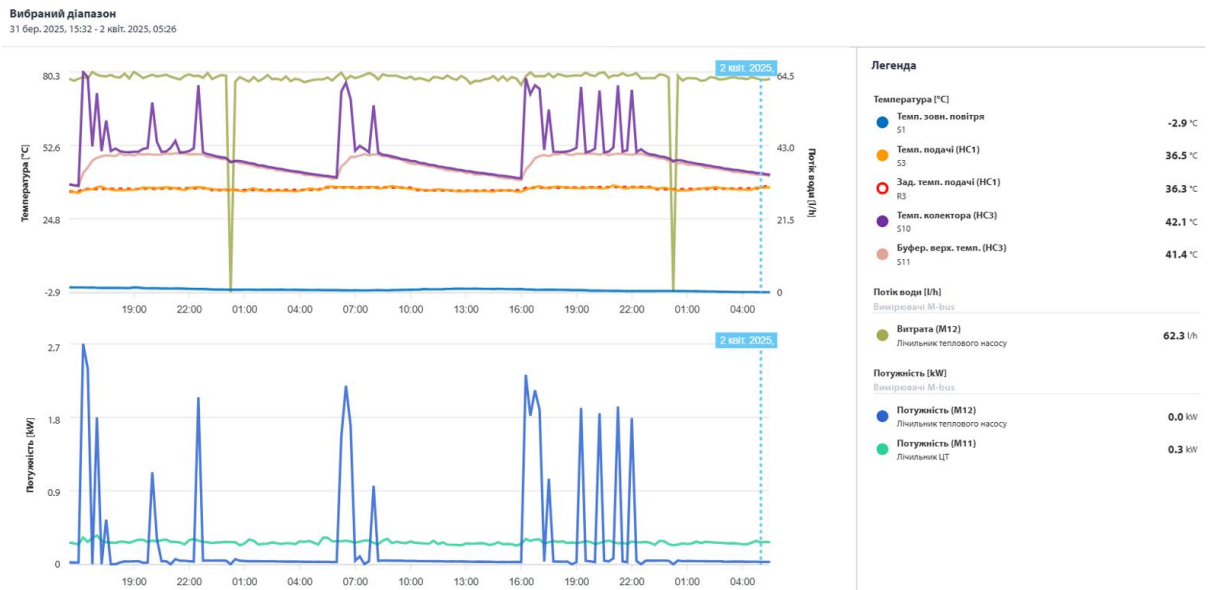
Рис.3.5 Поведінка локального джерела тепла при заряджанні акумулятора: температура на виході, витрата та теплова потужність у контурі локального джерела.
