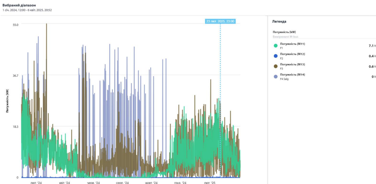
Рис.3.11 Графік динаміки теплових потоків у системі HRU супермаркету COOP365 Nordborg за період з 1 січня 2024 року по 6 квітня 2025 року
