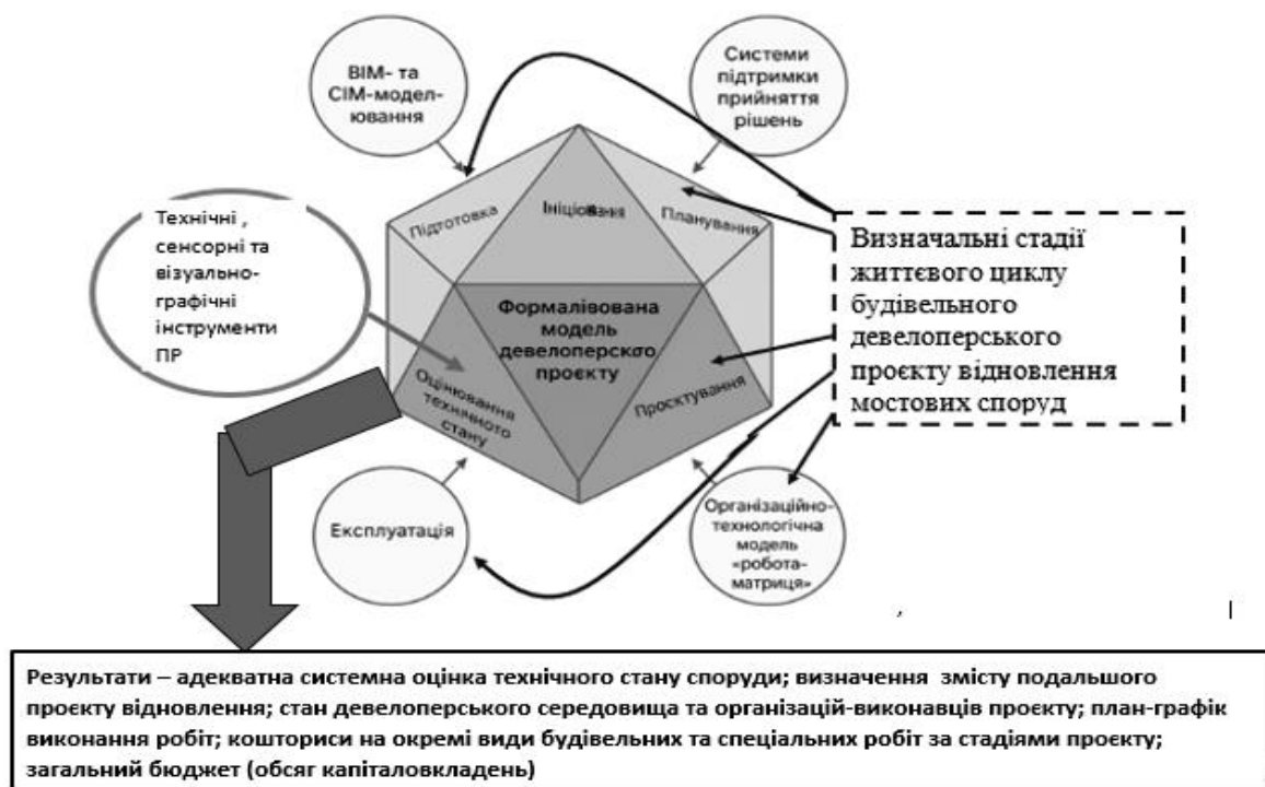
Рис. 3.31. Організаційно-технологічна модель формалізованого опису проєкту відновлення мостових споруд, що подана у вигляді цифрового багатогранника. Джерело розроблено автором
