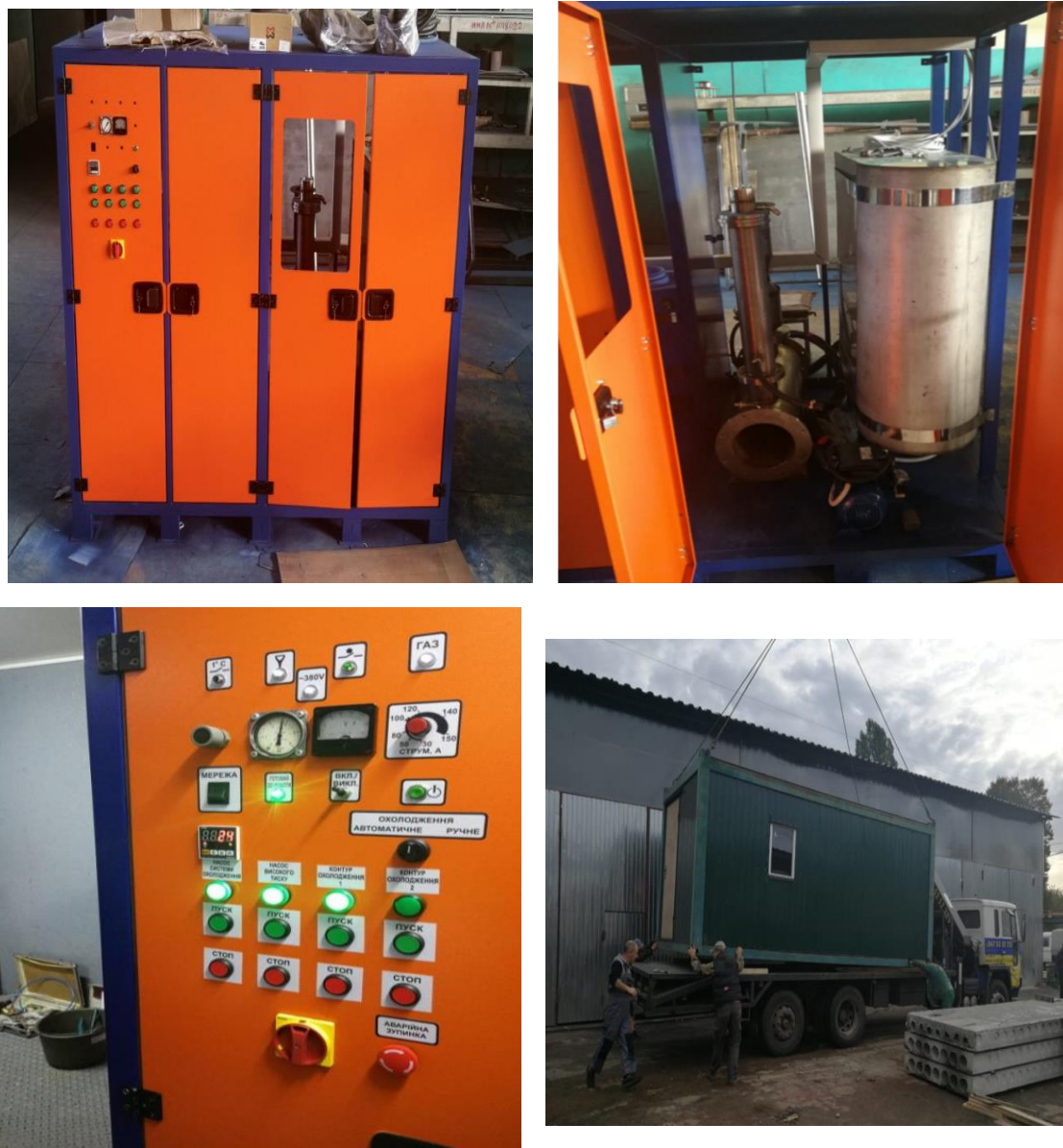
Рис. 3.2. Загальний вигляд мобільної установки «Плазмон-3М» на базі 20 футового контейнера. На верхньому фото (зліва) показано фронтальний вигляд плазмодугової установки «Плазмон 3М». На верхньому фото з права показано реакторне відділення установки. На фото внизу з ліва - панель керування установкою. На нижньому фото з права – мобільний 20-футовий контейнер, на даху якого розташовані охолоджуючі системи та димохідна труба
