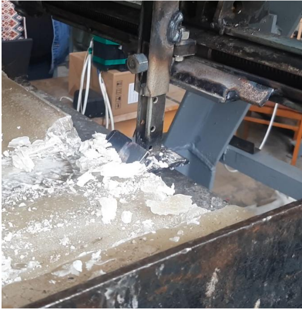
Рисунок 3.31. Процес різання парафіну рухомим просторово орієнтованим ножом
