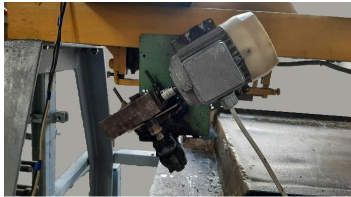
Рисунок 3.6. Розміщення електродвигуна приводу ножа та передач 1 – конічна передача; 2 – черв'ячна передача; 3 - електродвигун
