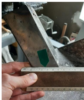
Рисунок 3.26. Встановлення мітки в центрі ріжучої кромки
