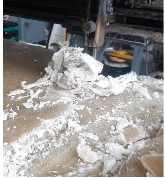
Рисунок 3.31. Процес різання парафіну рухомим просторово орієнтованим ножом
