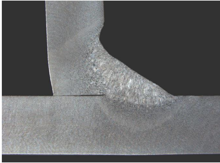
Рисунок 1.9. Підріз зварного шва
