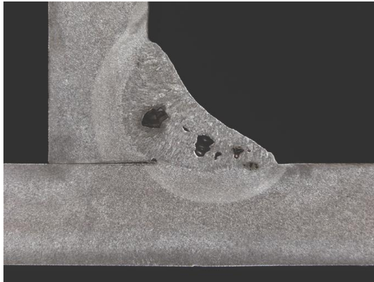
Рис.1.7. Пористість зварного шва
