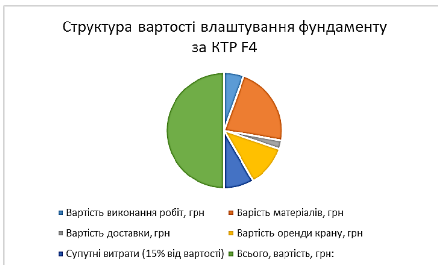
Рис. 4.14. Структура вартості влаштування фундаменту за конструктивно-технологічним рішенням КТР F_4 .
