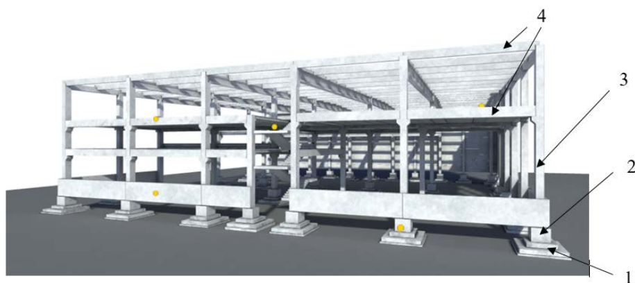
Рис. 1.1. Вигляд каркасної будівлі із збірного залізобетону:
