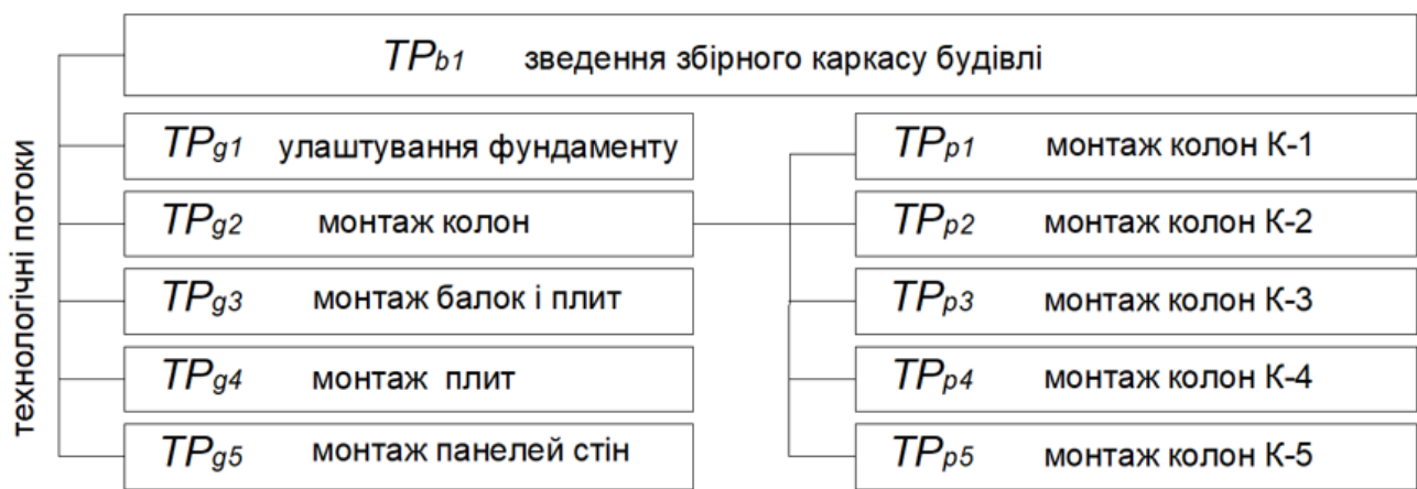
Рис. 3.1. Структура процесу монтажу збірного каркасу будівлі
