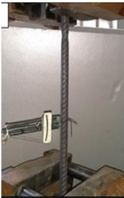
Рис.4.19. Процес випробування арматурних зразків за розтягу
