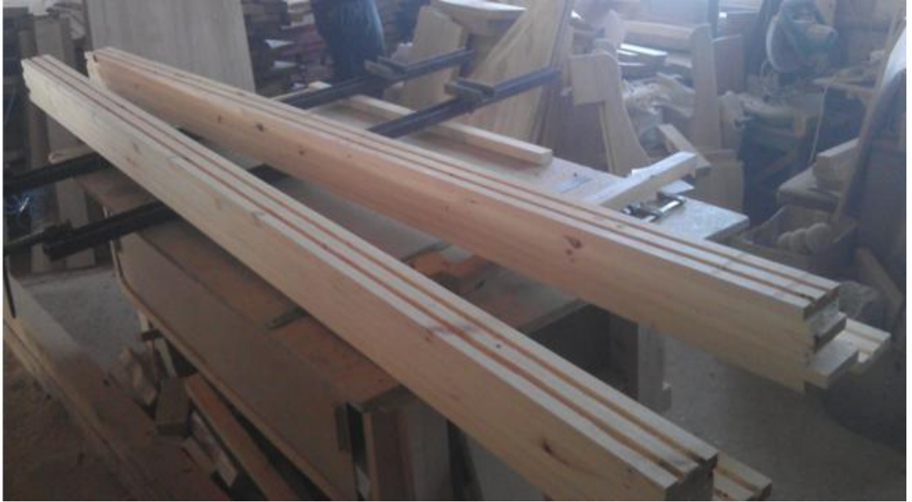
Рис. 4.3. Підготовка до влаштування сталеві арматури в пази стиснутої зони балок
