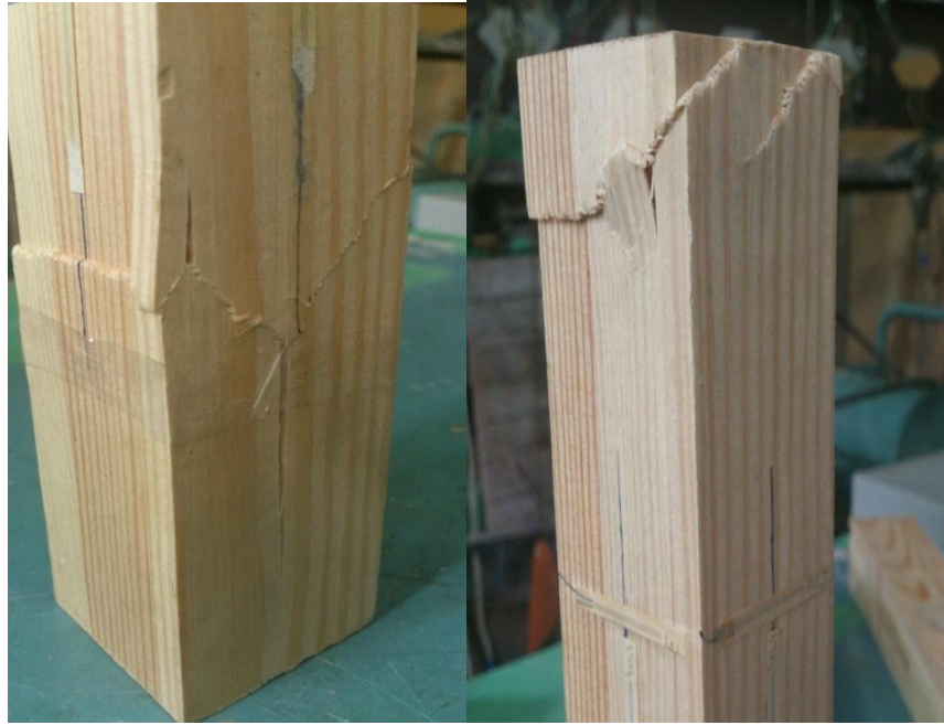
Рис. 5.3. Класичний характер руйнування зразків призм з цільної деревини сосни за повздовжнього стиску
