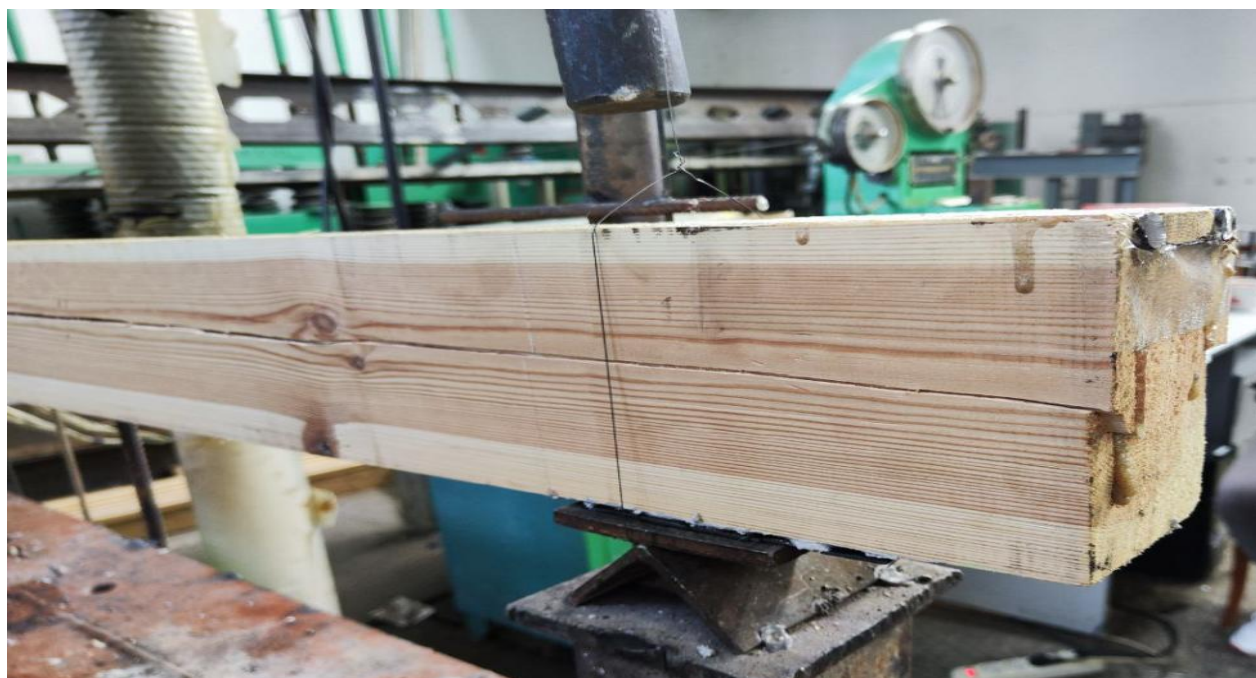
Рис. 5.21. Руйнування балки з цільної деревини SBR45(Prst) за рахунок сколювання деревини по площині вздовж елемента поблизу нейтральної лінії
