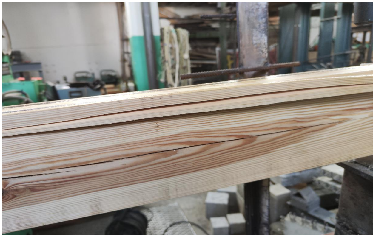
Рис. 5.20. Руйнування балки з цільної деревини SBR30(Prst) за рахунок сколювання частини деревини разом з арматурою
