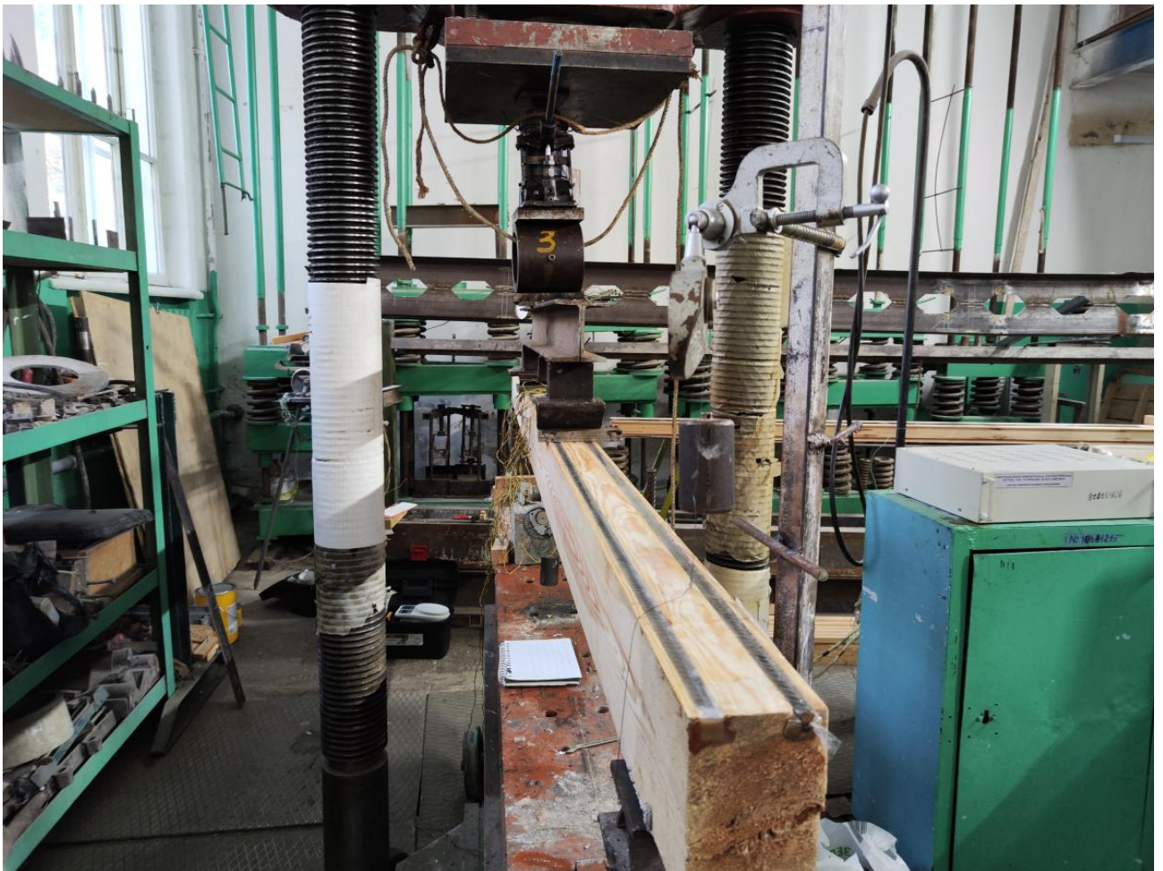
Рис. 4.21. Експериментальне дослідження балки з цільної деревини з пасивним комбінованим армуванням
