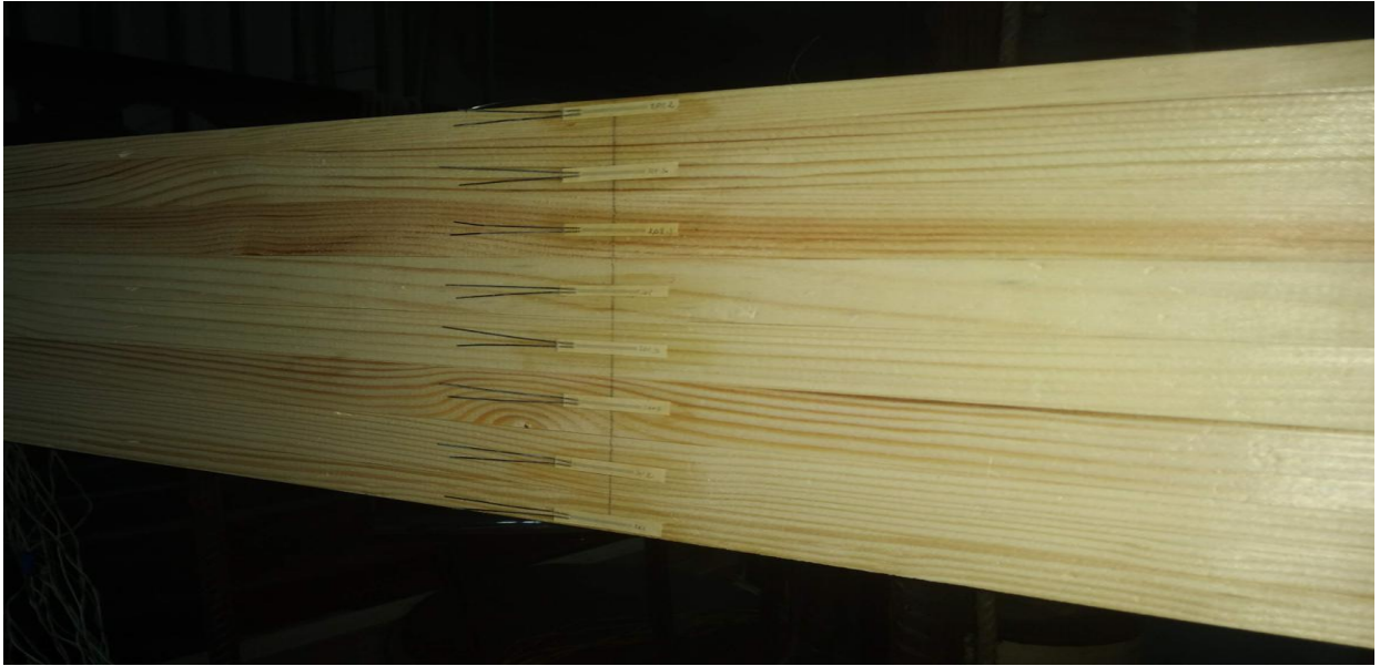
Рис. 4.9. Розміщення тензометричних датчиків по висоті досліджуваної балки
