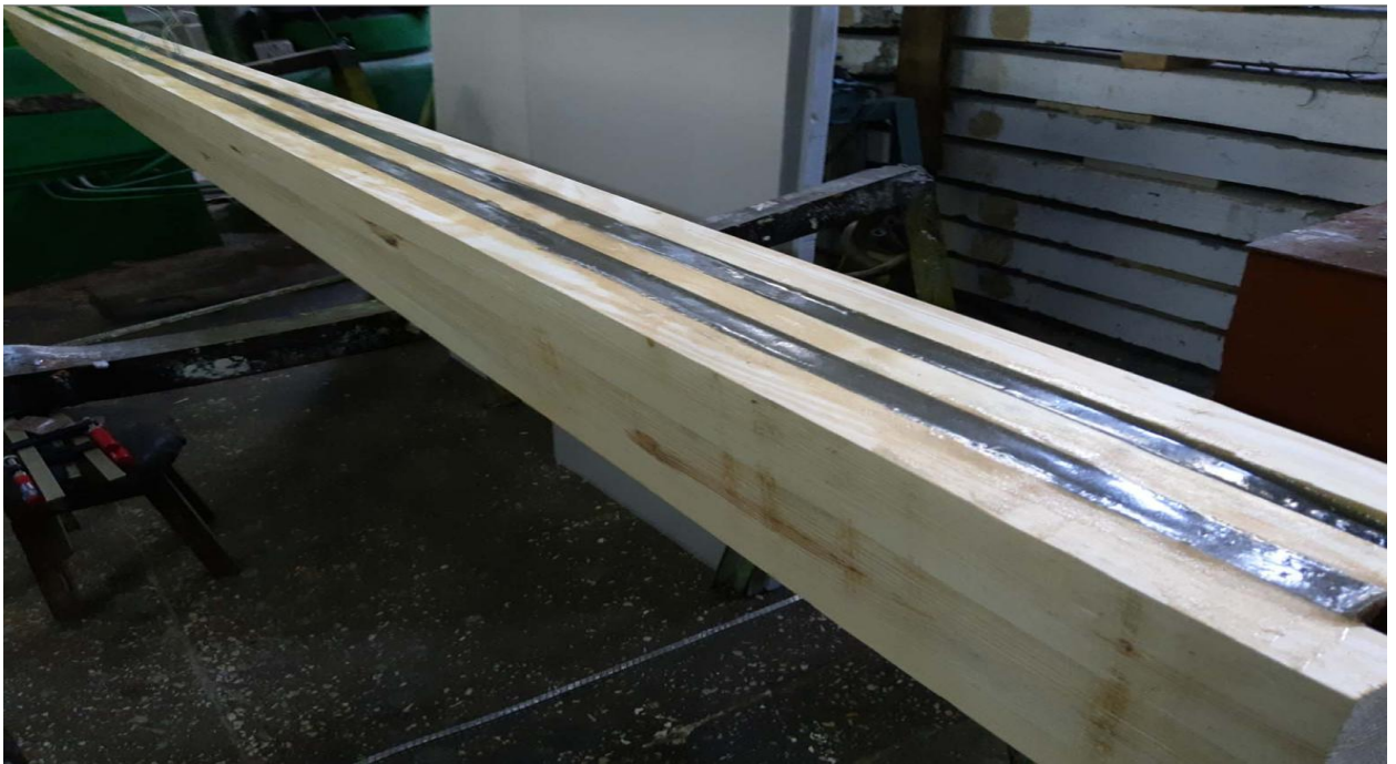
Рис. 4.6. Вклеювання сталльної арматури у пази зовнішньої чи передостанньої верхньої дошки стиснутої зони елемента з деревини
