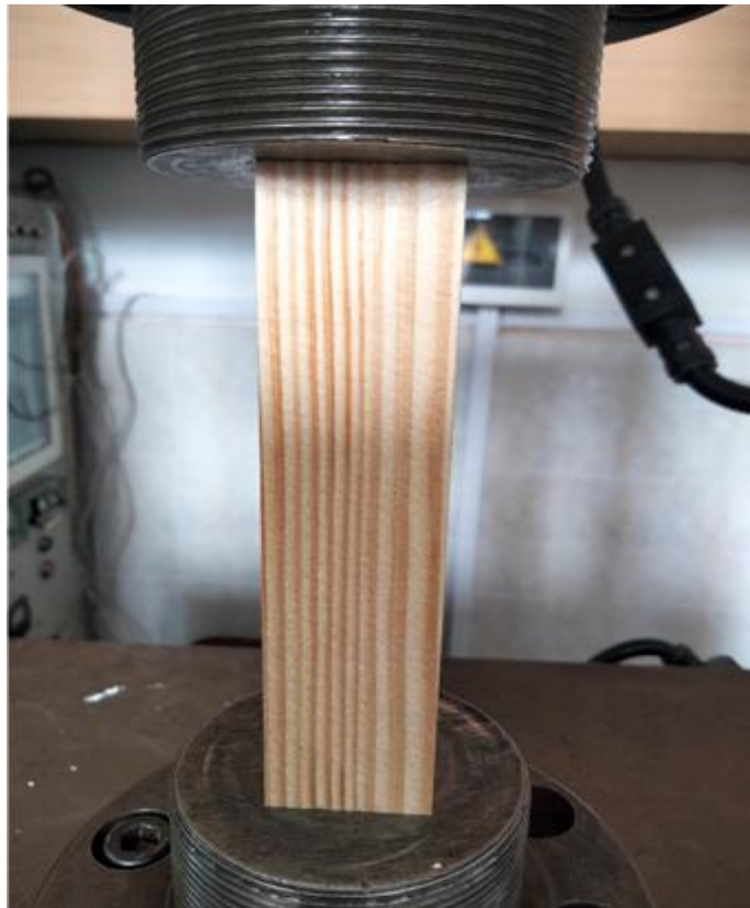
Рис.4.17. Процес випробування зразків призм з деревини сосни за повздовжнього стиску
