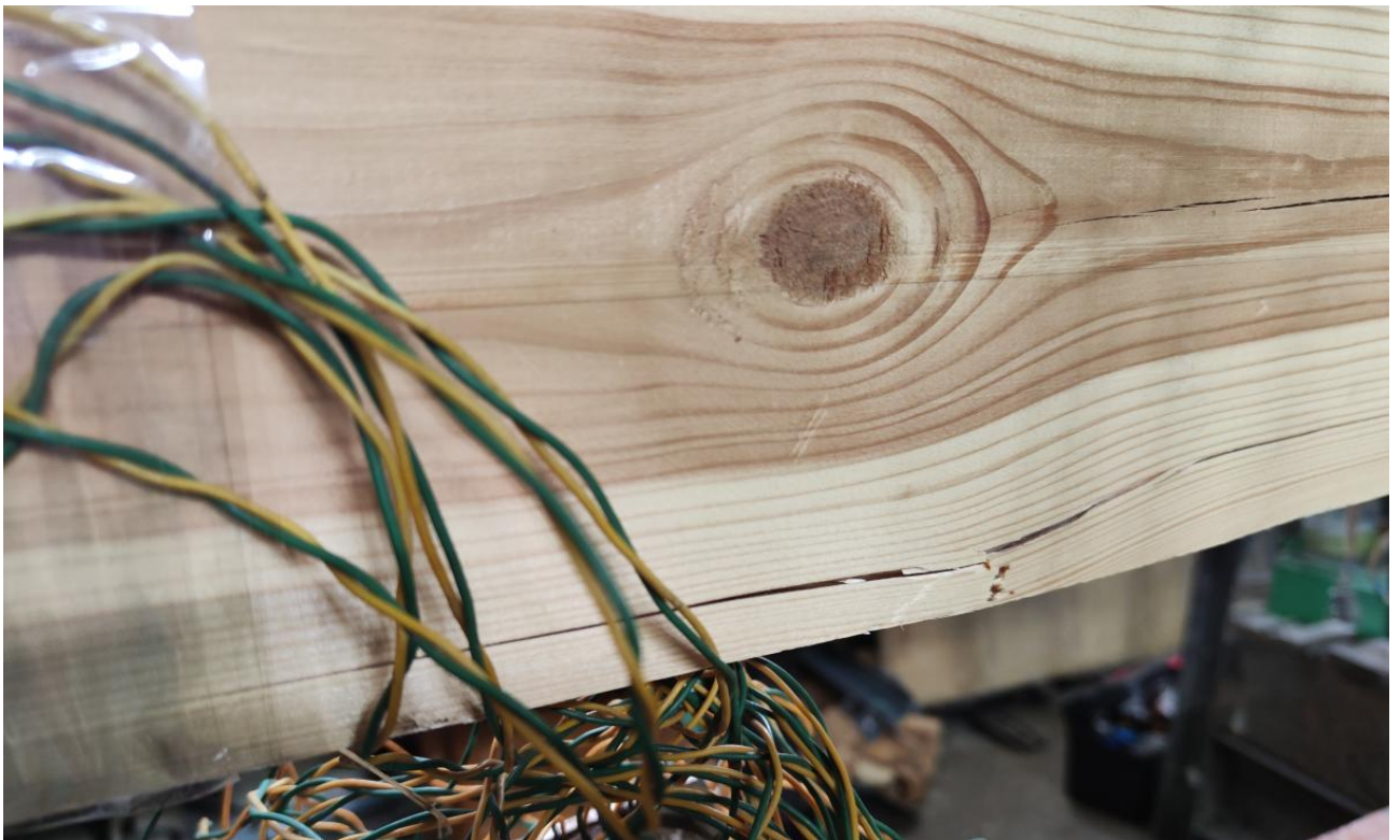
Рис. 5.7. Руйнування балки з цільної деревини SB пройшло за рахунок руйнування крайніх шарів деревини розтягнутої зони
