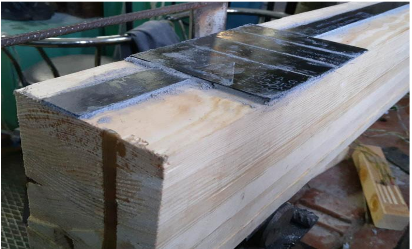
Рис. 4.13. Анкерування повздовжньої попередньо напруженої композитної стрічкової арматури Sika CarboDur S-512 на краях елемента
