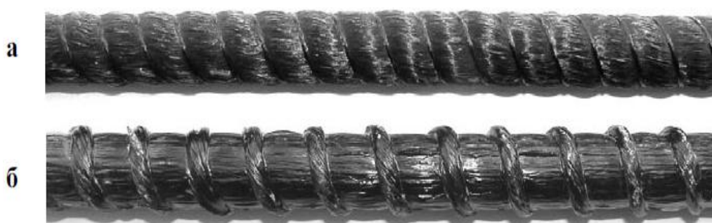
Рис. 1.6. Види періодичного профілю рифленої неметалевої композитної арматури: а - спіральна намотка із вдавлюванням джгута в тіло стержня; б – поверхнева спіральна намотка без вдавлювання джгута в тіло стержня
