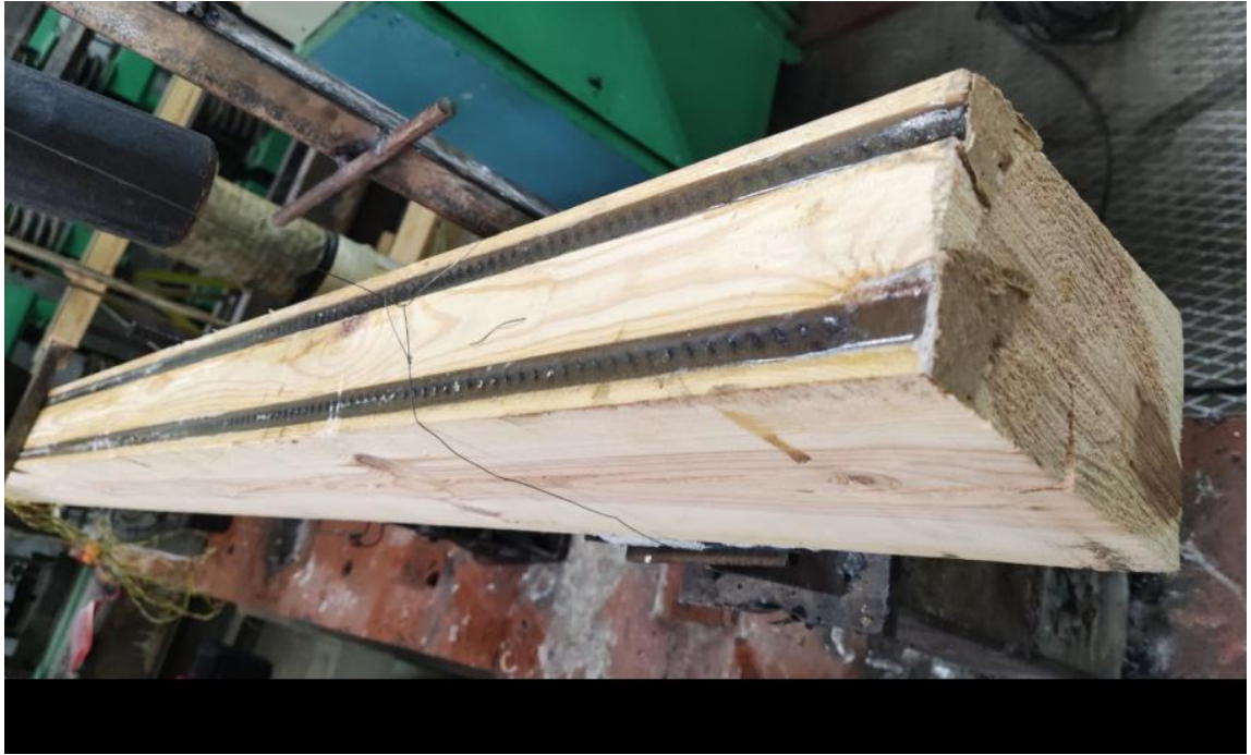
Рис. 4.4. Період кристалізації клейового розчину в пазах балки
