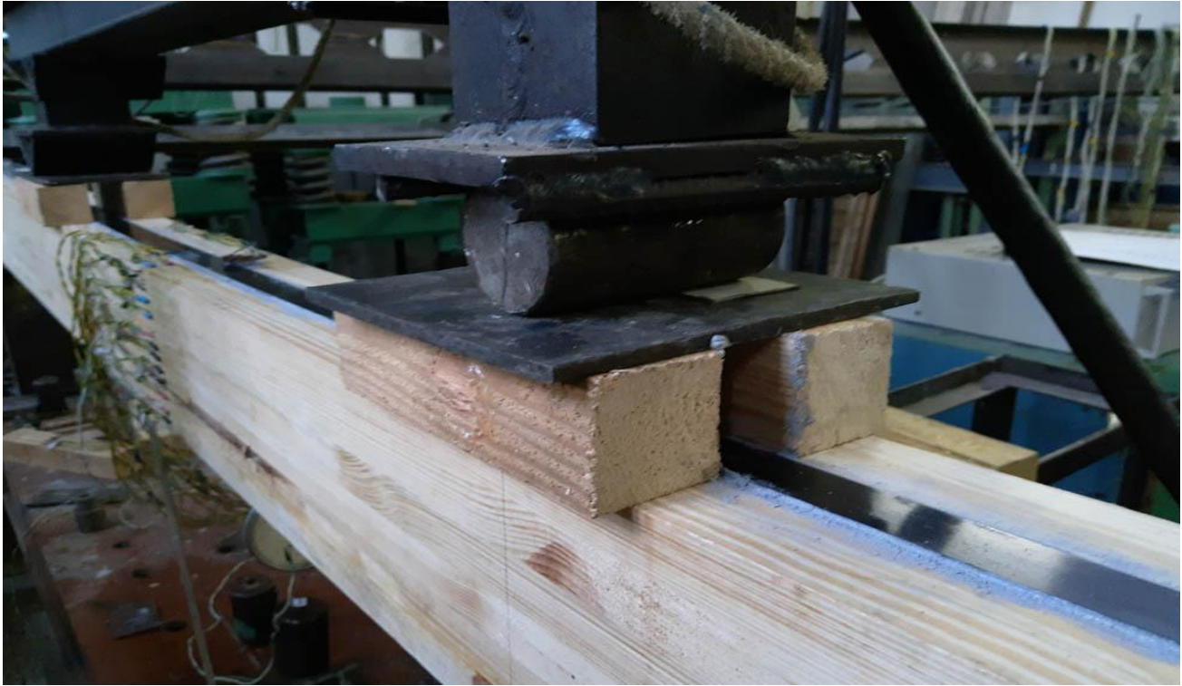
Рис. 4.12. Розташування композитної стрічкової арматури Sika CarboDur S-512 під опорами, що надають вигин балки
