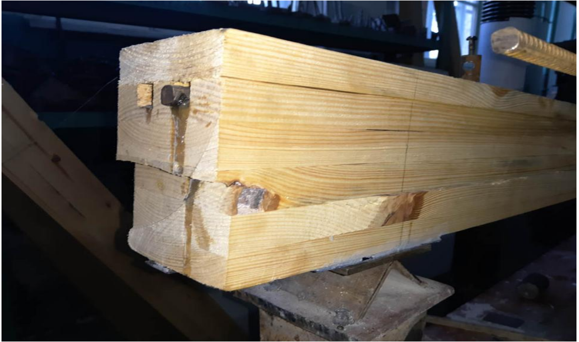
Рис. 6.9. Характер руйнування попередньо напруженої комбіновано армованої балки з клеєної деревини GRB-12 (Prst)
