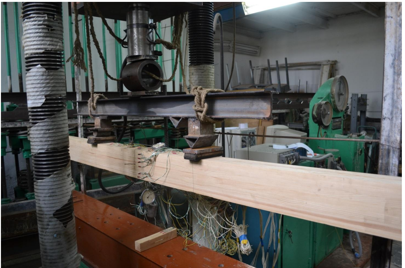
Рис. 4.20. Експериментальне дослідження балки з клеєної деревини GB
