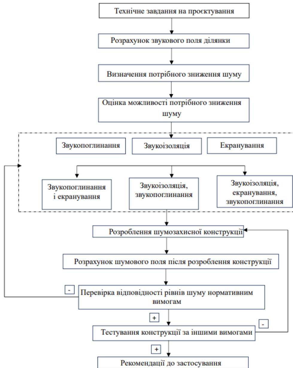
Рис. 4.3. Алгоритм процесу розроблення й тестування шумозахисної конструкції.
