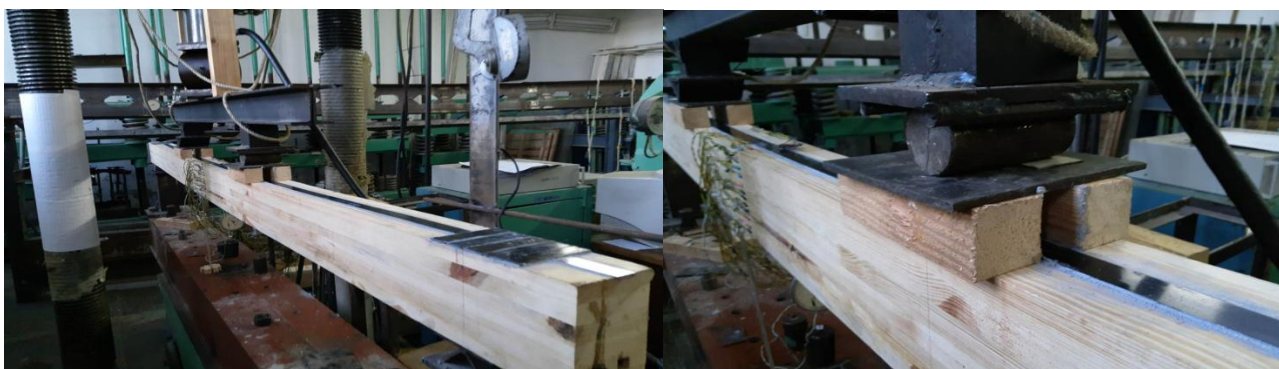
Рис. 18. Процес приклеюванні композитної стрічкової арматури Sika CarboDur S-512 до деревини балки
