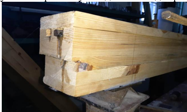
Рис. 22. Характер руйнування попередньо напруженої комбіновано армованої балки з клеєної деревини GRB-12 (Prst)
