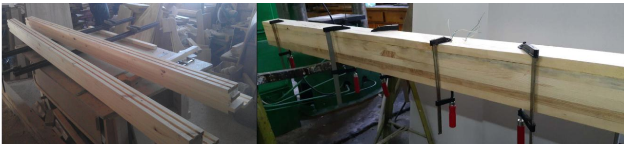
Рис. 17. Процес виготовлення дослідних зразків із клеєної деревини
