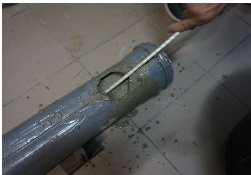
Рис. 3.5. Процес розподілення бетонної суміші в порожнині плити:
