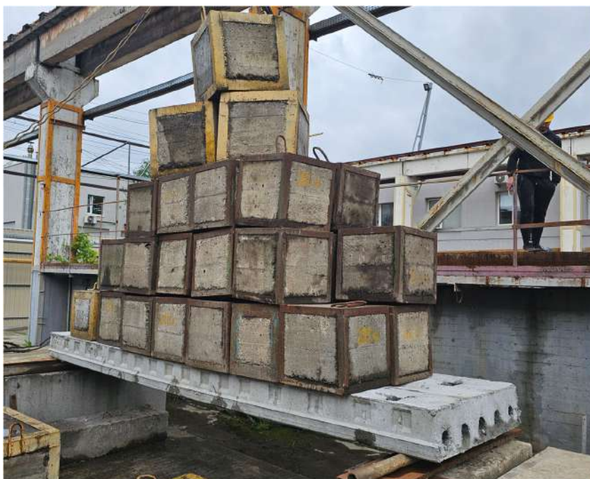
Рис. 3.29. Процес випробування підсиленої плити
