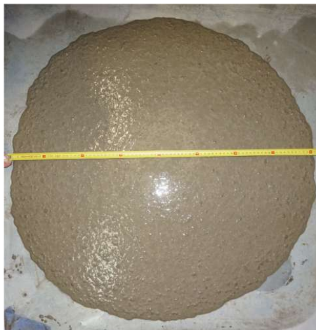
Рис. 2.2. Результати визначення консистенції використаних бетонних сумішей: а – бетонна суміш загального призначення; б – бетонна суміш із додаванням пластифікатора; в – бетонна суміш із додаванням суперпластифікатора
