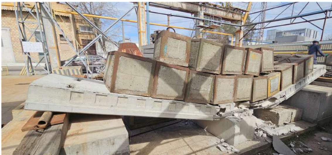
Рис. 3.15. Зовнішній вигляд плити після випробування
