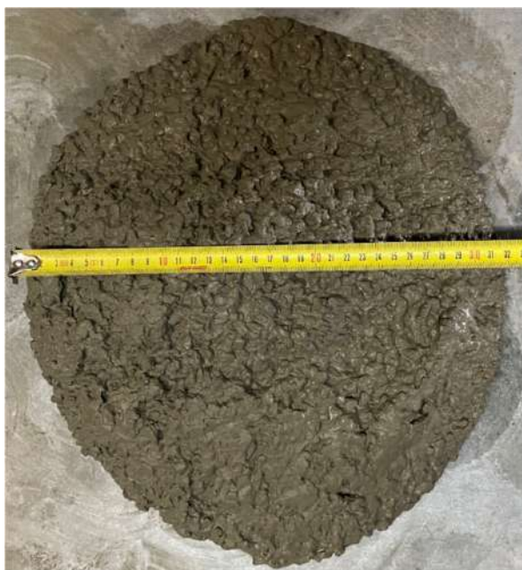
Рис. 2.2. Результати визначення консистенції використаних бетонних сумішей: а – бетонна суміш загального призначення; б – бетонна суміш із додаванням пластифікатора; в – бетонна суміш із додаванням суперпластифікатора
