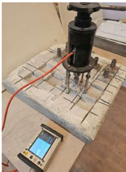
Рис. 2.4. Процес визначення міцності зчеплення бетонів
