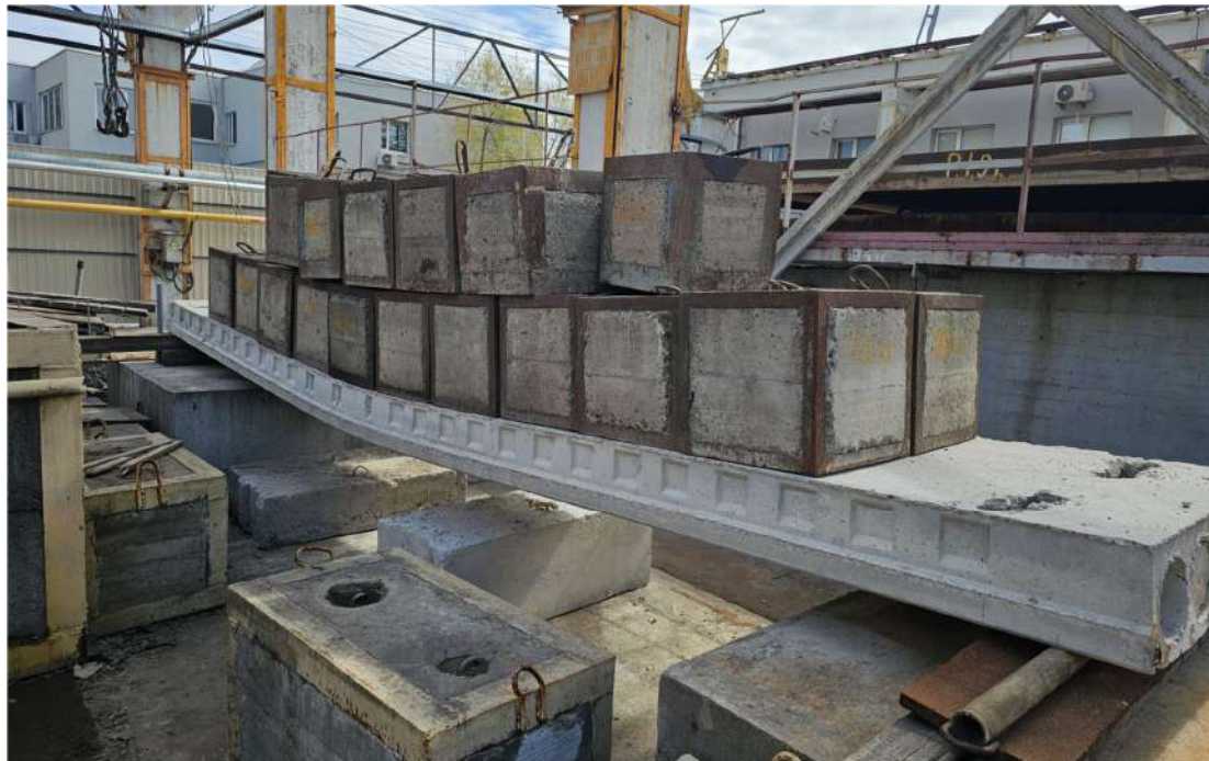
Рис. 3.14. Процес навантаження плити
