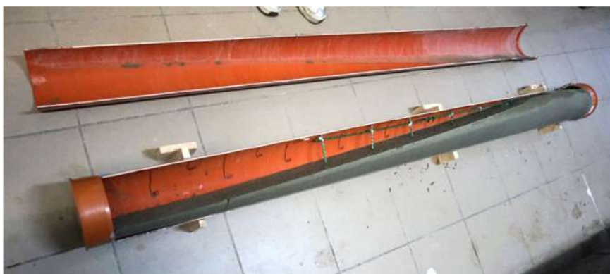
Рис. 3.2. Результати заповнення труб бетонними сумішами: а – бетонна суміш загального призначення; б – бетонна суміш із додаванням пластифікатора; в – бетонна суміш із додаванням суперпластифікатора
