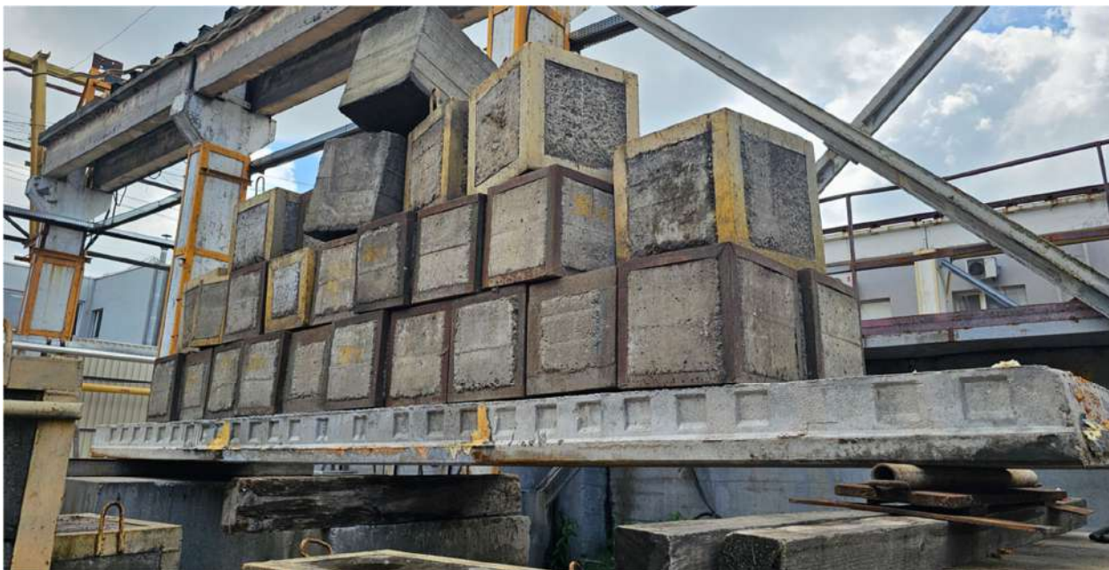
Рис. 3.20. Процес повторного випробування відновленої плити
