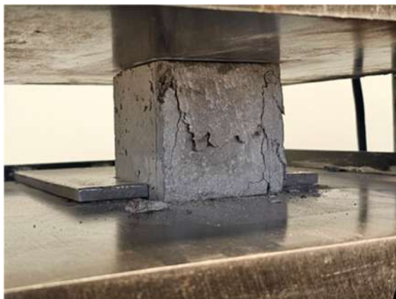
Рис. 2.3. Процес визначення міцності кубів
