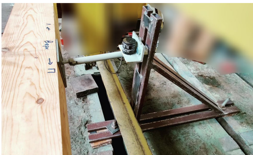
Рисунок 2.10 – Електронний датчик закріплений на опорі
