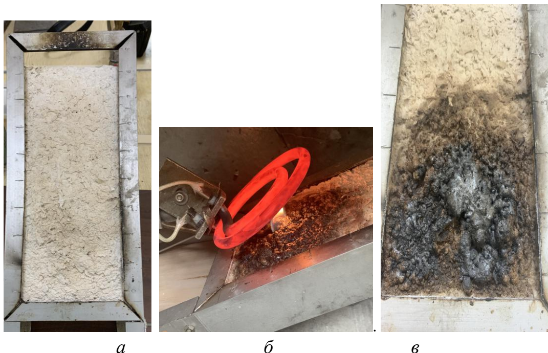
Рис. 3. Результати випробувань процесу займання та поширення полум'я біокомпозитом на органічній основі: а – зразок для випробувань, б – термічна дія на зразок, в – спучення зразка
