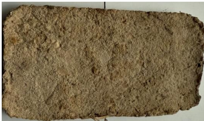
Рис. 1. Модельні зразки біокомпозиту з деревної тирси і суміші гіпсу та інтумесцентного покриття на основі ПВА-дисперсії
