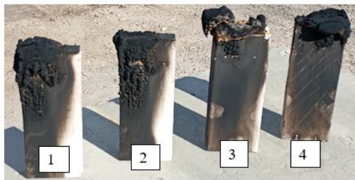
Рис. 2. Зразки біокомпозитів з деревини після термічної дії: 1 – МДФ, 2 – ДСП, 3 – деревина, 4 – фанера
