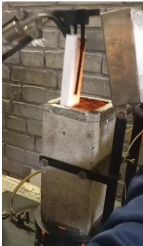
Рис. 1. Процес горіння зразків біокомпозитів під час вогневого впливу
