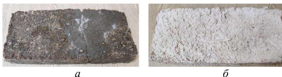
Рис. 1. Модельні зразки біокомпозиту: a – на основі стружки деревини – неорганічне в'язуче, б – на основі стружки деревини – органічне в'язуче
