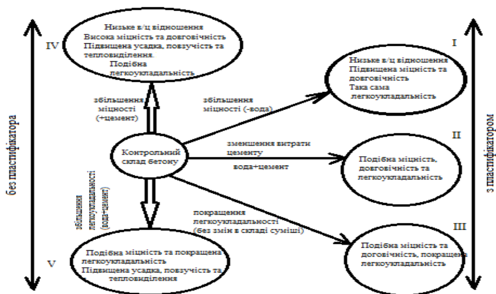
Рисунок 1.1 – Схема зміни властивостей бетону при введенні пластифікуючих добавок [68]
