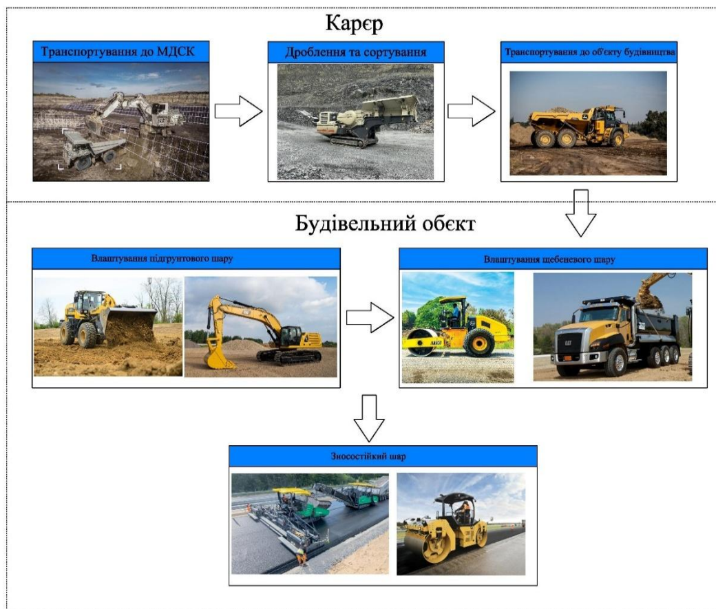
Рис.1.3. Схема застосування основних типів машин для влаштування доріг.
