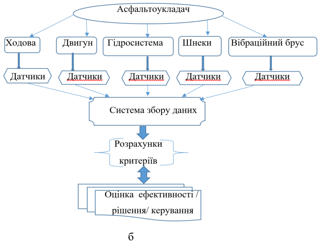
Рис.2.7 Схема моніторингу збірних одиниць та деталей: а –щогової дробарки; б – асфальтоукладача.
