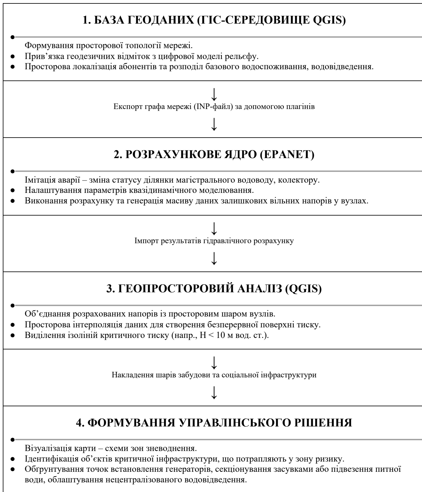
Рисунок 3.4.2. Геопросторова схема інтеграції ГІС QGIS та розрахункових модулів для ідентифікації зон критичного зниження вільного напору під час імітації аварійного виходу з ладу магістрального водоводу, колектора
