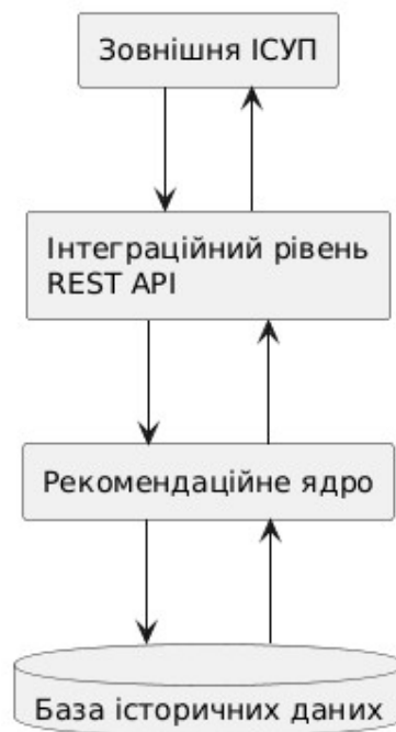
Рисунок 4.4 – Схема інтеграції інформаційної технології з зовнішніми інформаційними системами
