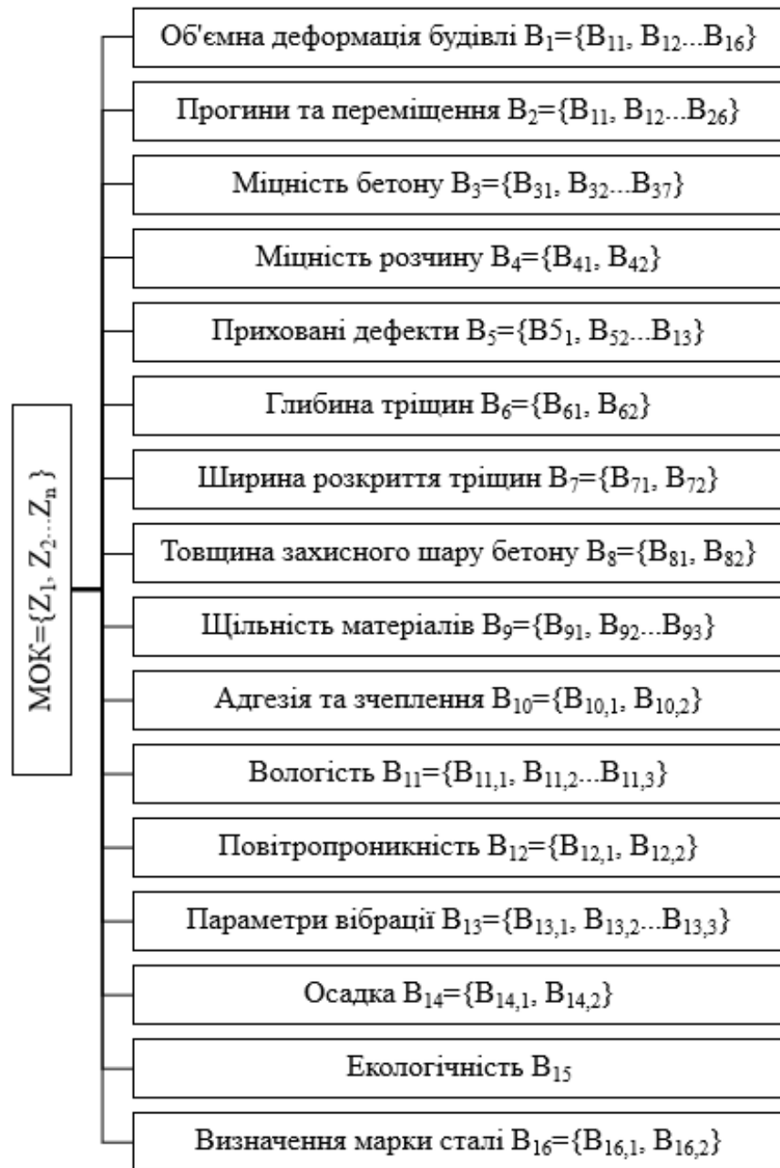
Рис. 5. Структурно-функціональна модель методів інструментального обстеження каркасів будівель (Джерело: розроблено автором)
