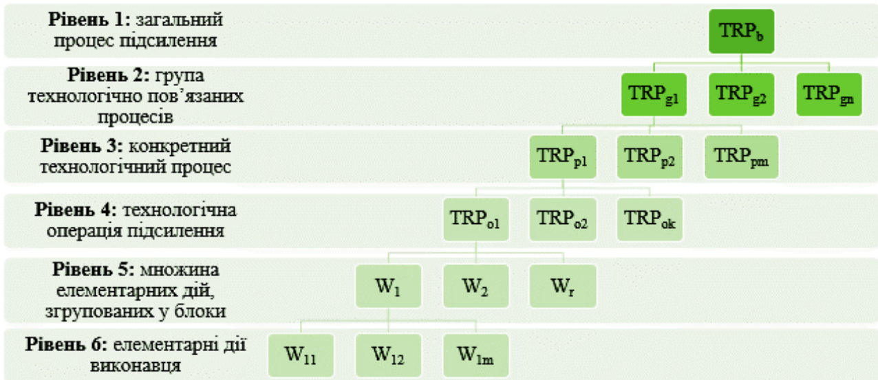
Рис. 13. Ієрархічна структура будівельного процесу реконструкції (Джерело: розроблено автором)
