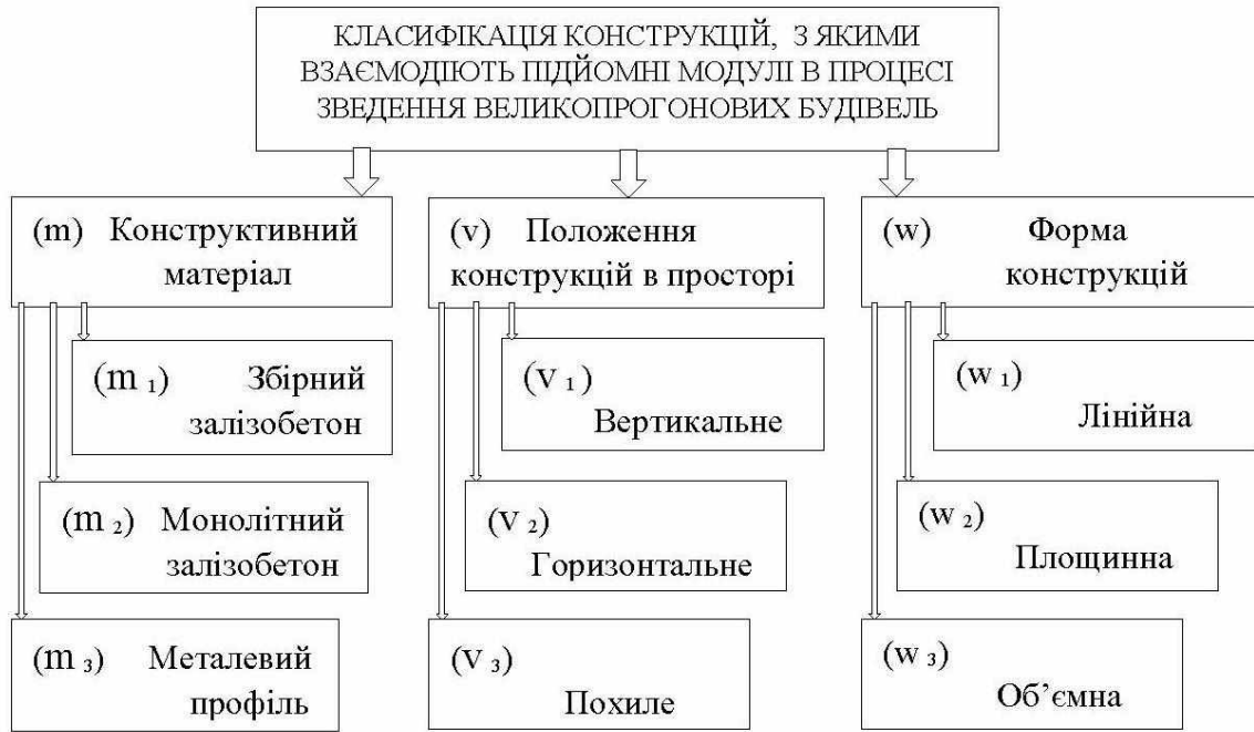
Рис. 2.13 Розширена класифікація конструкцій, з якими взаємодіють ПМ при зведенні великопрогонових будівель
