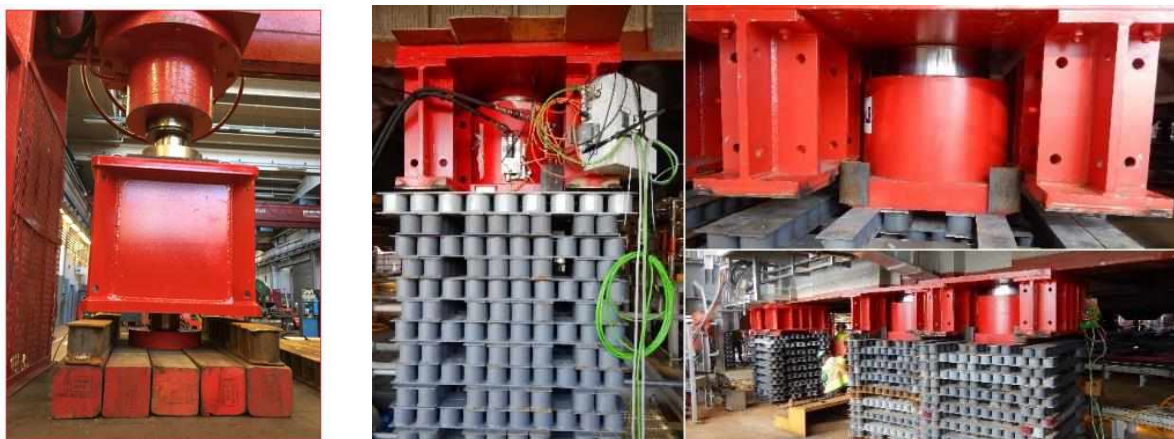
Рис. 1.23 Гідравлічний домкрат двосторонньої дії FAGIOLI 600
