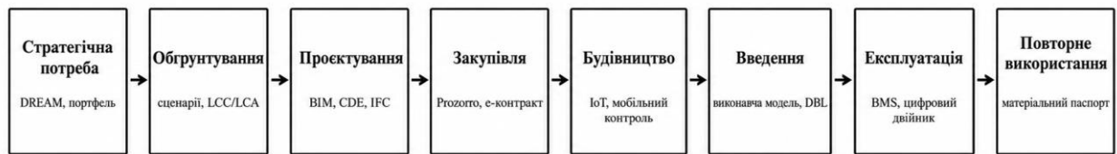
Рис. 3.22. Цифрова нитка життєвого циклу проєкту біосферосумісного будівництва
