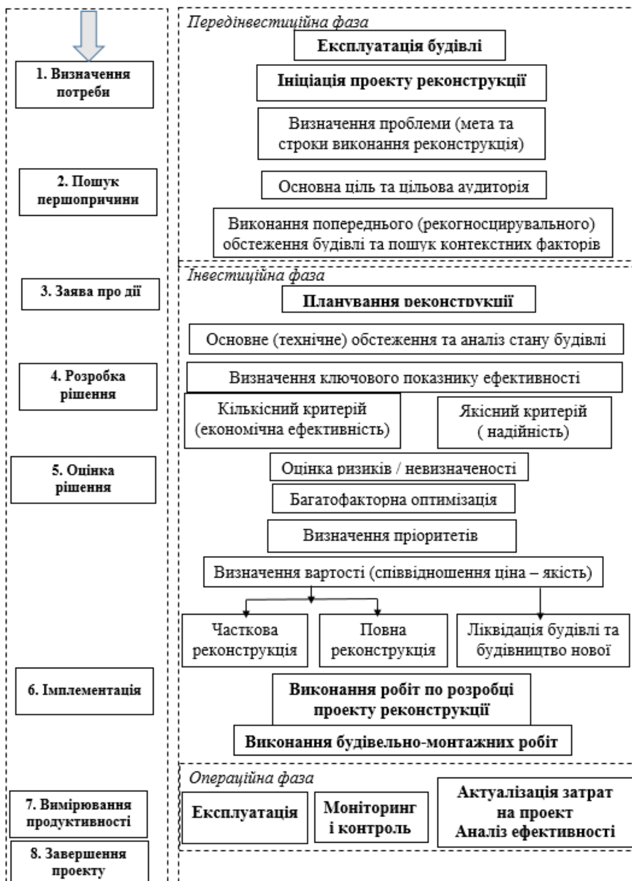
Рис. 2.1. Модель життєвого циклу інвестиційно-будівельного проекту забезпечення якості підсилення каркасних будівель під час реконструкції [168]
