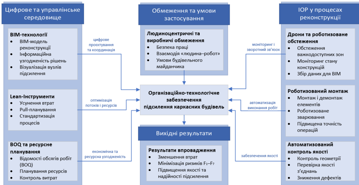
Рис. 6.21. Схема інтеграції BIM-, Lean- та IOP-технологій в організаційно-технологічне забезпечення процесів підсилення каркасних будівель
