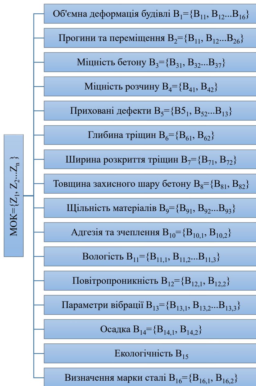
Рис. 3.13 Структурно-функціональна модель методів інструментального обстеження каркасів будівель
