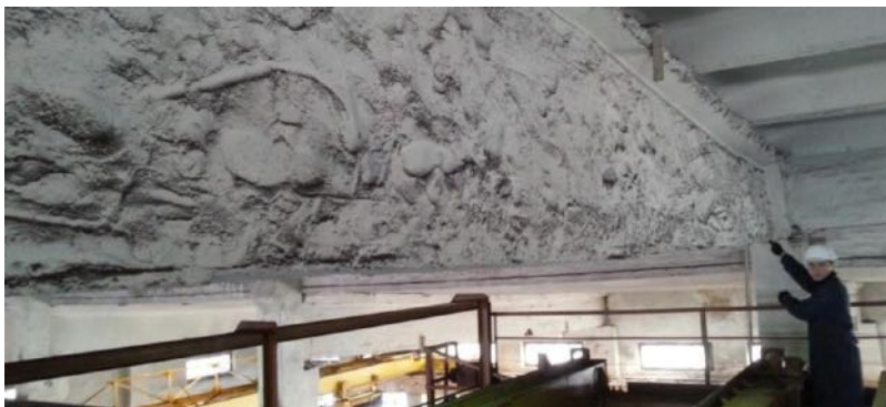
Рис. 3.5. Визначення прогину з використанням сталевोї нитки, яку натягують уздовж нижнього поясу обстежуваної конструкції. ПАТ «ДОНБАСЕНЕРГО»
