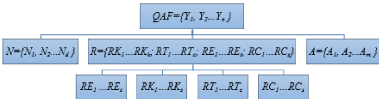
Рис. 2.11. Ієрархічна структура функції оцінювання якості (QAF) підсилення каркасних конструкцій, що інтегрує критерії надійності (N), ефективності (R) та сталості (A)
