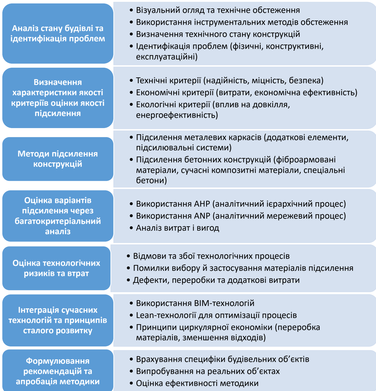
Рис. 2.3. Блок-схема алгоритму побудови методики дослідження якості підсилення каркасних будівель у межах конструктивно-технологічної системи
