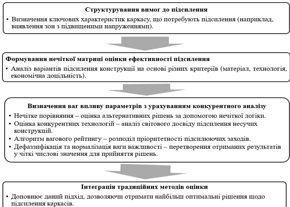
Рис. 1.13. Концептуальна схема параметричного вибору КТР підсилення каркасів
