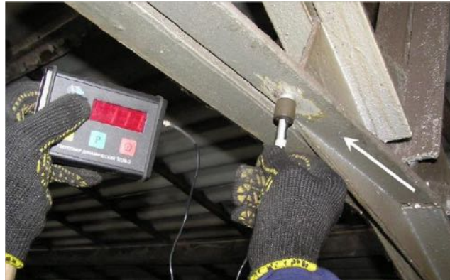
Рис. 3.9. Визначення твердості сталі ферми за допомогою динамічного твердоміра ТДМ-2. Цех № 24 ВАТ «Донецькгірмаш»
