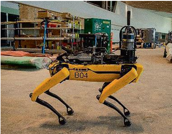
Рис. 6.19. Пот-робот для автономної фотозйомки 360°
