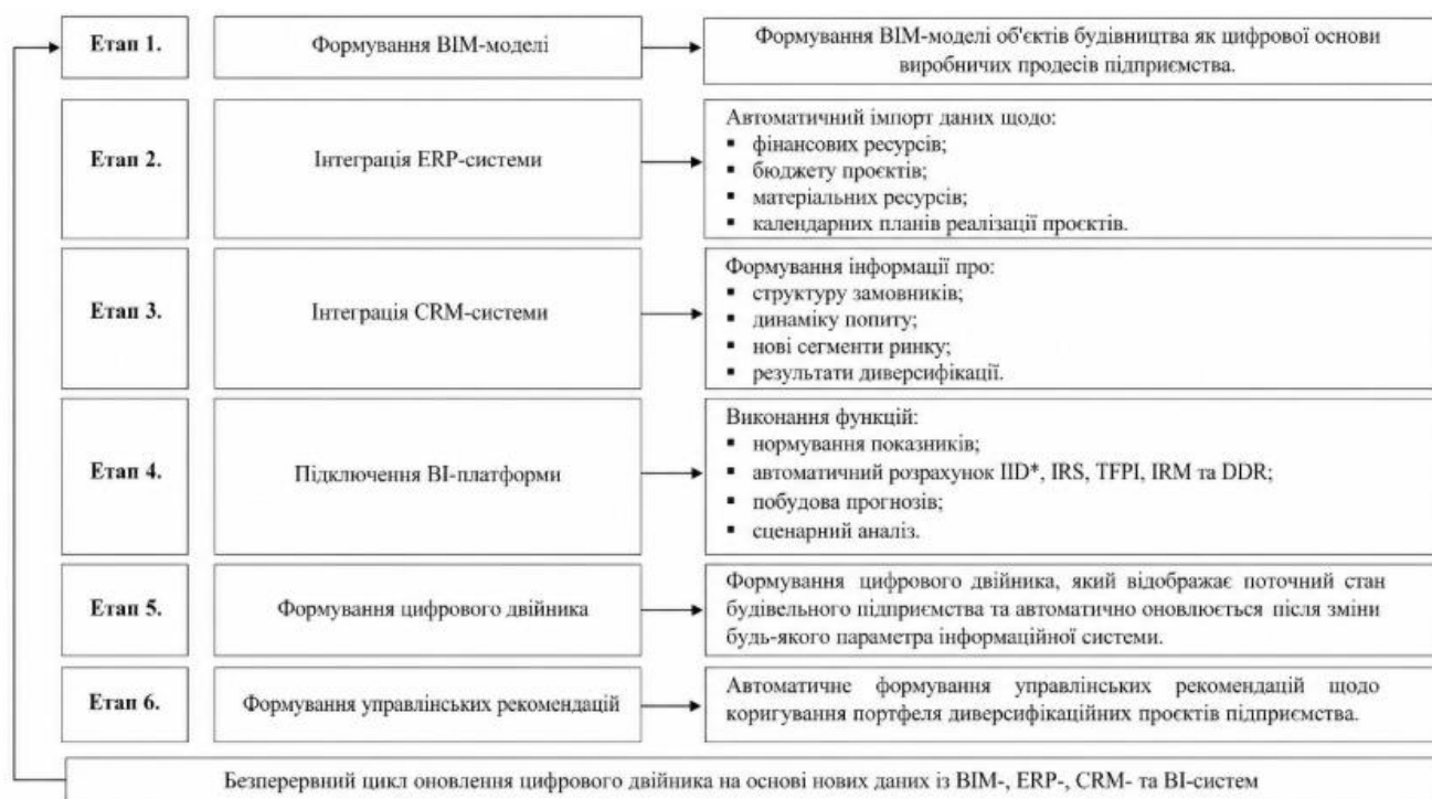
Рис. 3.8. Алгоритм створення цифрового двійника будівельного підприємства
