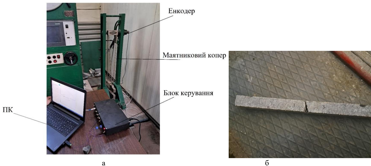
Рис. 28 Вимірювально- реєструвальне обладнання та результат досліду: а – підключення до маятника; б – зруйнований зразок після удару маятником
